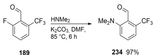
Schema 86 Darstellung von Aldehyd **234** ausgehend von **189**. Durch Umsetzung mit Dimethylamin konnte das Produkt in einer Ausbeute von 97% erhalten werden.
