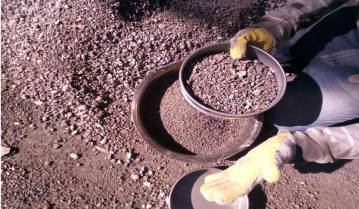
Figura 19. Tamizado del concreto compactado después de la trituración. Fuente: Autor
