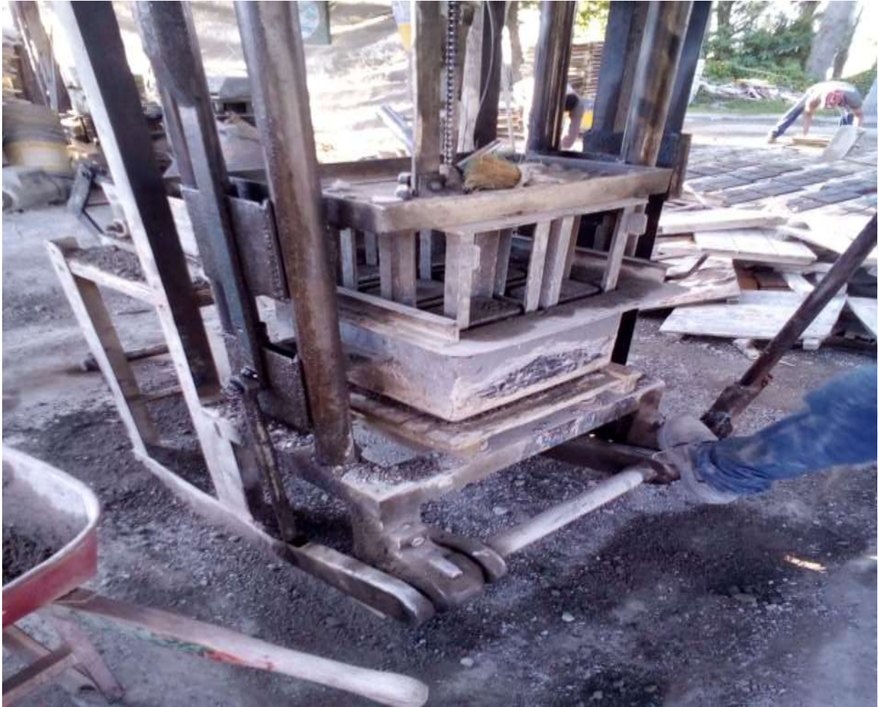
Figura 21. Moldeado de los bloques de concreto y RCD. Fuente: Autor
