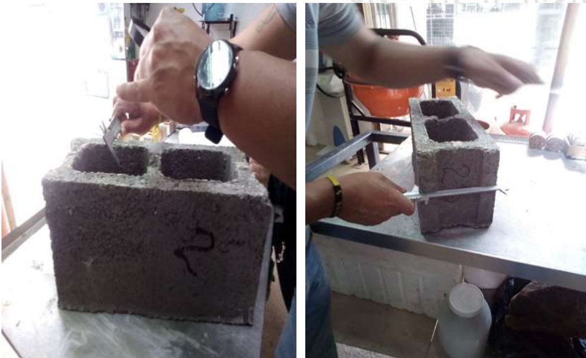
Figura 24. Medición de las unidades de mampostería de concreto y RCD. Fuente: Autor
