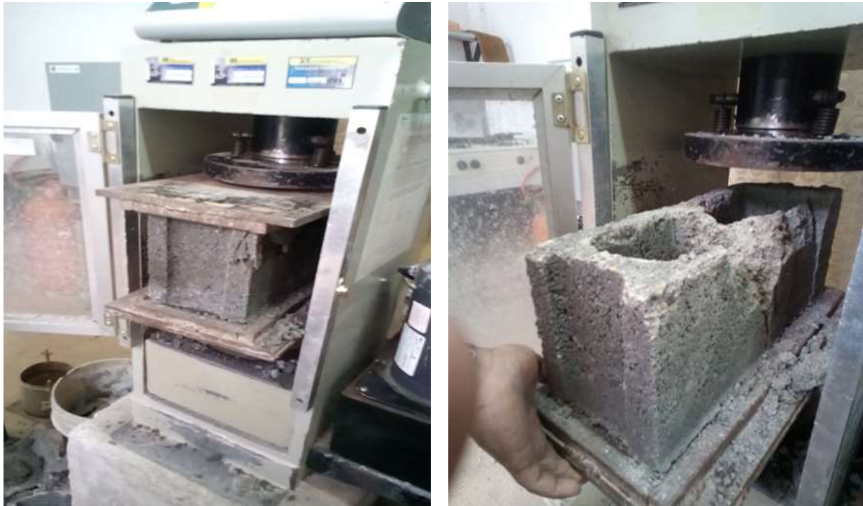
Figura 25. Ensayos de laboratorio- resistencia a la compresión. Fuente: Autor
