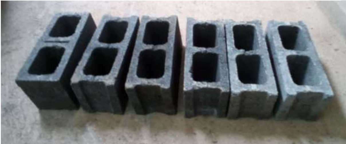
Figura 23. Unidades de mampostería de concreto limpias para iniciar fallas de laboratorio. Fuente: Autor
