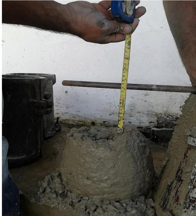
*Figura 140.* Ensayo se asentamiento como slump.
