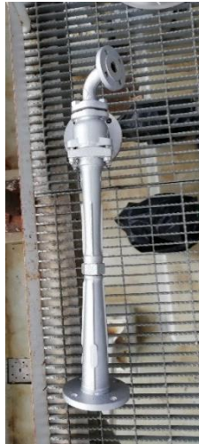
Figura. 23 Eyector flash cooler
