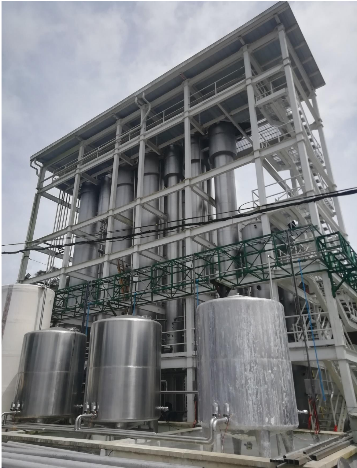
Figura. 1 Evaporador de película descendente planta lácteos San Pedro COLANTA.
