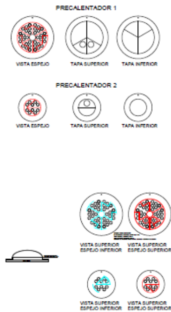
Figura. 35 Rediseño de flujos en el pasteurizador
