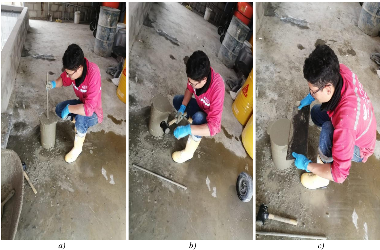
Ilustración 6. Ensayo de rendimiento volumétrico del concreto. a) compactación b) chipoteado c) enrase.
