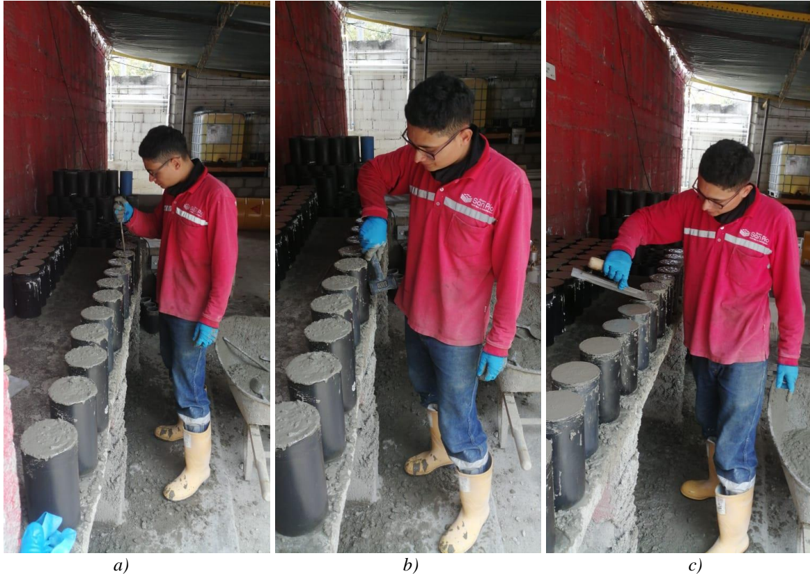
Ilustración 10. Elaboración de especímenes de concreto. a) compactación b) chipoteado c) enrase.
