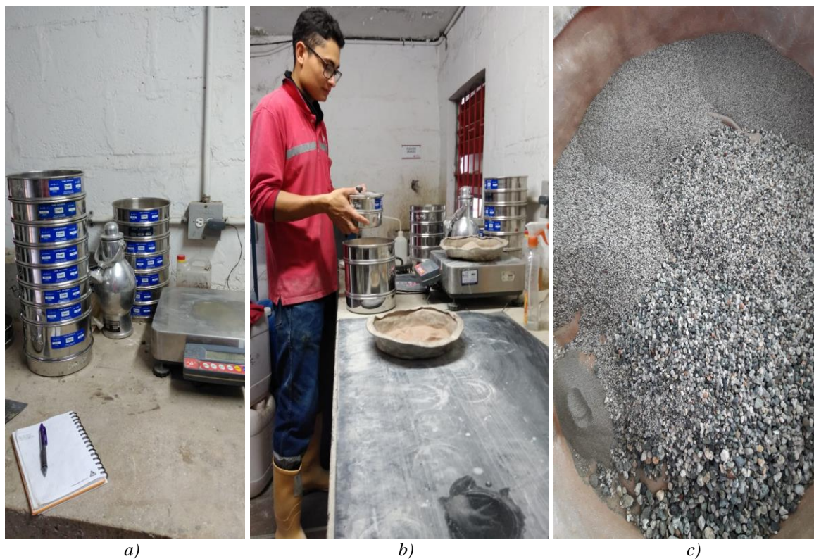
Ilustración 4. Gradación de agregados finos y gruesos. a) tamices b) ensayo de gradación c) gradación arena.
