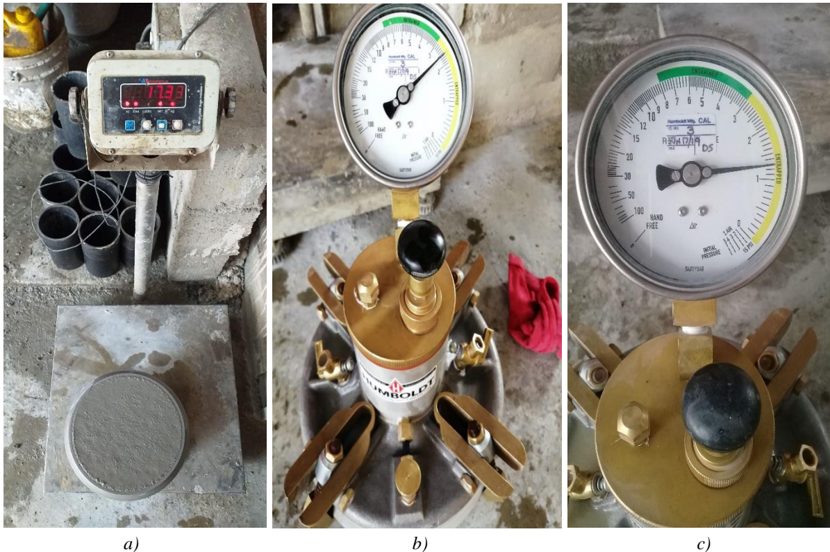
Ilustración 9. Características del ensayo del contenido de aire del concreto, método de presión. a) Planeidad y bordes limpios b) sellado hermético c) Manómetro.
