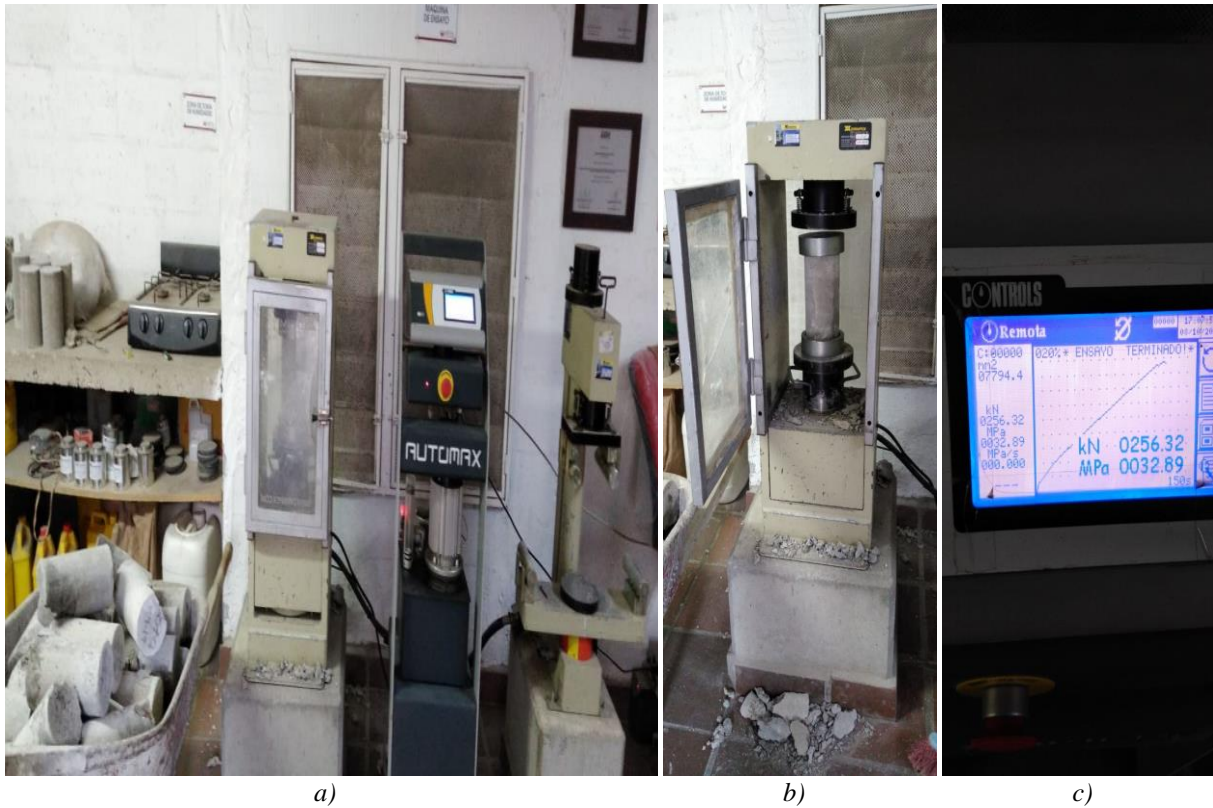
Ilustración 11. Máquinas de compresión axial y flexión de especímenes cilíndricos y vigas rectangulares respectivamente.
