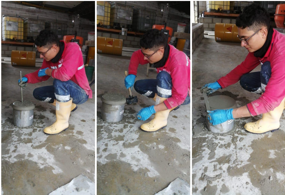
Ilustración 8. Ensayo del contenido de aire del concreto, método de presión. a) compactación b) chipoteado c) enlace.
