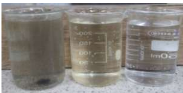
Figura 48 De izquierda a derecha: Agua luego de la trampa de grasa, luego del proceso de coagulación-floculación y tratamiento completado. Fuente: elaboración propia
