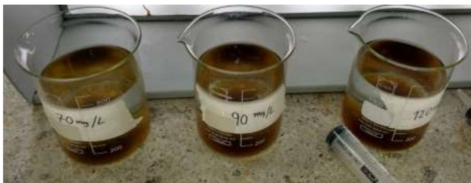
Figura 8 Etapa de reposo, donde se espera que los coloides formados durante el mezclado se sedimenten. Fuente: elaboración propia
