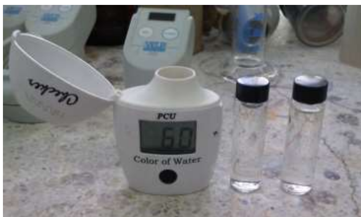
Figura 12 Checker del color de agua en plena lectura. Fuente: elaboración propia
