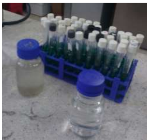
Figura 30 Muestras para ensayo de conteo de coliformes en frascos con previa esterilización. Fuente: elaboración propia
