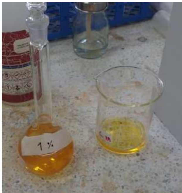
Figura 4 Solución al 1% de cloruro férrico, nuestro agente coagulante. Fuente: elaboración propia
