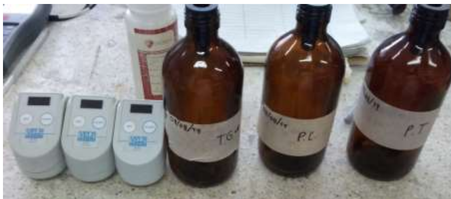
Figura 17 Botellas de vidrio color ámbar junto a sensores DBO EVO. Fuente: elaboración propia
