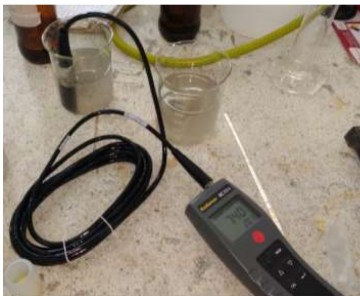
Figura 20 Medidor de conductividad y salinidad Ecosense EC 300A. Fuente: elaboración propia
