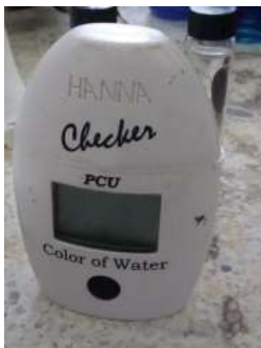
Figura 11 Chercker Hanna para la medición del color del agua. Fuente: elaboración propia
