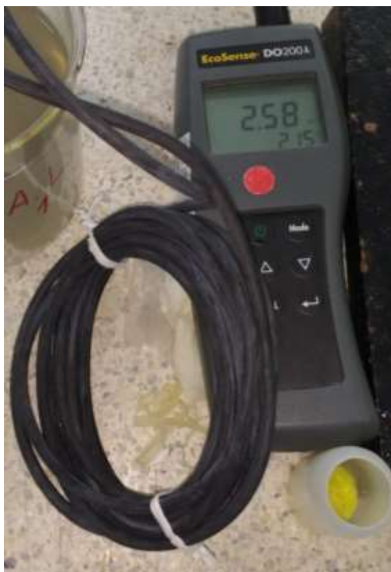
Figura 19 Medidor de Oxígeno disuelto EcoSense DO 200A. Fuente: elaboración propia
