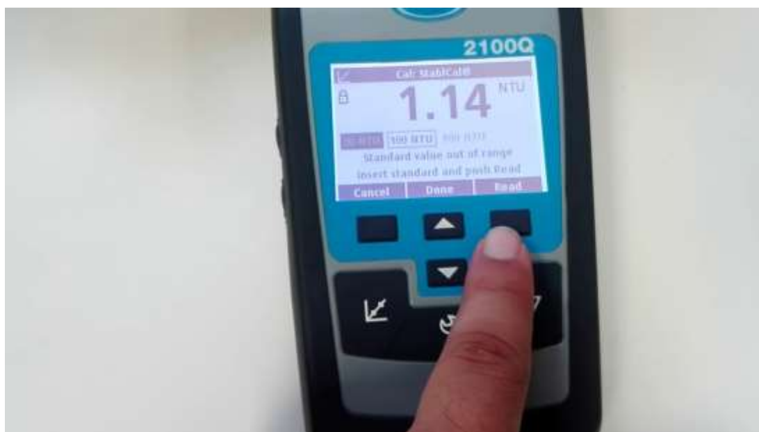
Figura 13 Turbidímetro portátil tomando lecturas de turbidez. Fuente: Google imágenes
