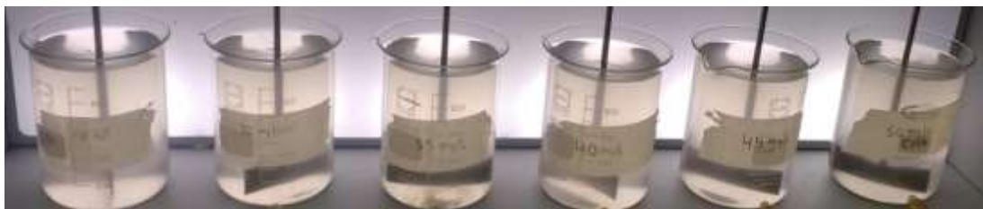
Figura 3 Arreglo del ensayo de jarras llenas de muestra de agua residual. Fuente: elaboración propia
