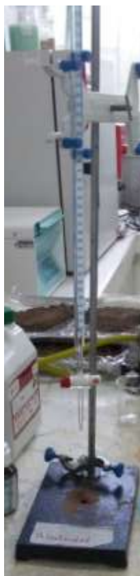
Figura 23. Bureta de vidrio bricolado, volumen de 50 mL. Fuente: elaboración propia
