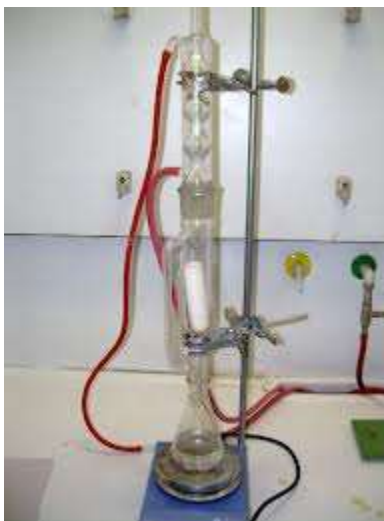
Figura 28 Aparato de extracción, soxlet, con un frasco de extracción de 125 mL. Fuente: Google imágenes
