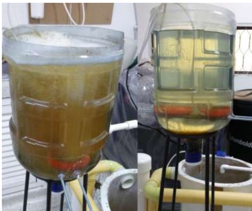
Figura 37. Muestra durante y al finalizar el proceso de coagulación-floculación. Fuente: elaboración propia
