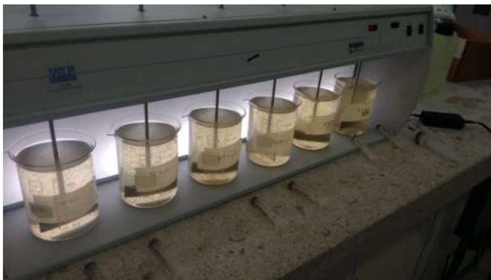
Figura 6 Ensayo de jarras en plena inicio de ejecución. Fuente: elaboración propia
