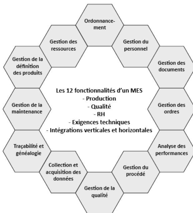
Figure 2.1 Fonctionnalités d’un MES adaptées de la norme ANSI/ISA-95
