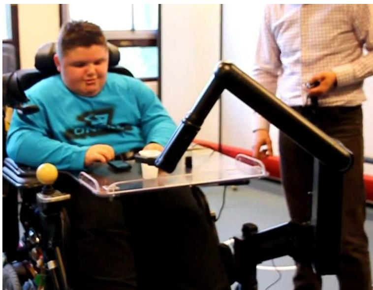
Figure 1.4 Système d'assistance utilisant MANUS (Tiré de [15])
