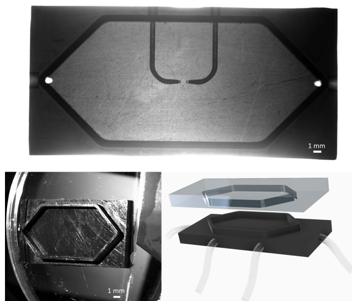
Figure 4.8 Deuxième version du dispositif. En haut, image au microscope illuminée fortement par en dessous pour visualiser les canaux internes. Le trait noir hexagonal plus foncé correspond au "rail" que l'on voit sur les autres images. En bas à gauche, image avec profondeur du même dispositif au microscope. En bas à droite, vue CAD de l'assemblage : des tubes sont branchés dans les trous, et une plaque de PDMS creusée d'une tranchée s'emboîte avec le rail pour sceller le dispositif.
