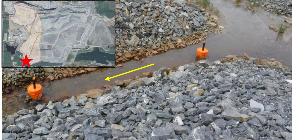
Figure 3.5 : Station de mesure Sud, située en aval de la jonction des fossés Ouest 1 et Ouest 2 (à droite de la photo) deux capteurs sont installés dans les chaudières orange. L'emplacement de la station de mesure est indiqué par une étoile rouge sur la photo aérienne dans le coin supérieur gauche. La section est rectiligne et située tout juste avant une chute significative du profil du fossé menant au Bassin SW (à gauche sur la photo). La flèche jaune indique la direction de l'écoulement.
