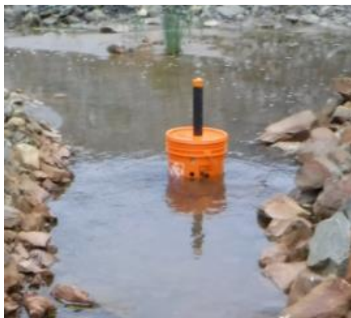
Figure 3.2 : Capteur amont de la Station de Mesure Nord installé dans un fossé collecteur sur le site de la Mine Canadien Malartic (Station de mesure Nord). La chaudière orange remplie de roches permettait de maintenir le tube crépiné (noir). Le capteur de pression d'eau était placé à l'intérieur du tube. Le sceau et le tube étaient perforés afin de permettre l'écoulement de l'eau.
