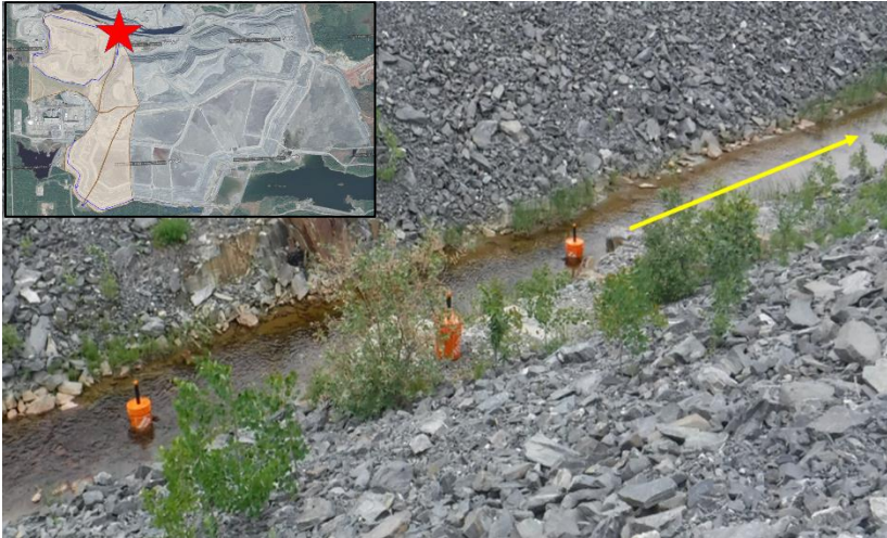
Figure 3.4 : Station de mesure Nord, deux capteurs sont installés dans les chaudières orange alors qu'une troisième (au centre de la photo) est placée à l'air libre et mesure la pression atmosphérique. L'emplacement de la station de mesure est indiqué par une étoile rouge sur la photo aérienne dans le coin supérieur gauche. La flèche jaune indique la direction de l'écoulement.
