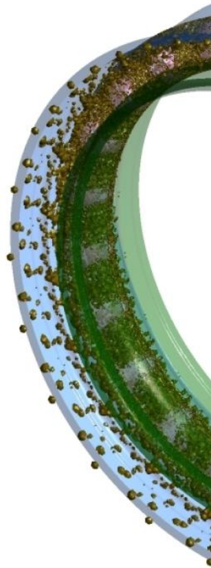
Figure 2.7 – Étude de la génération de gouttelettes dans un secteur périodique de roulement à billes par la méthode CLSVoF (13 000 rpm) (Adeniyi, Morvan, & Simmons, 2015)
