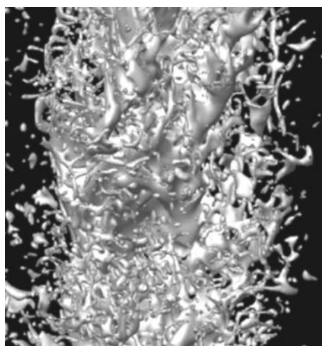
Figure 2.9 Instabilités d'un jet liquide et formation de gouttelettes (Menard et al., 2007) ainsi que comparaison avec l'atomisation d'un jet Diesel photographié par Yon (2003)
