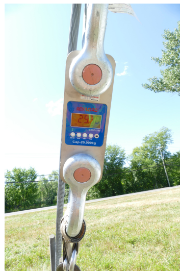
Figure C.4 Affichage du dynamomètre - Photographie Najib Bouaanani
