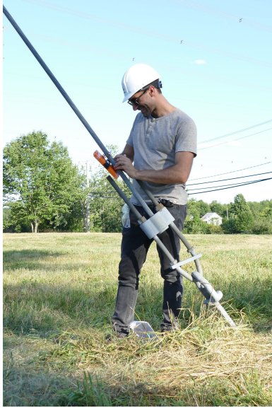
Figure C.5 Fixation du téléphone intelligent sur le hauban - Photographie Najib Bouaanani
