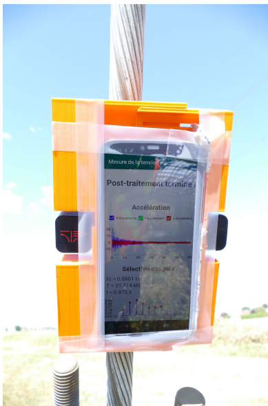
Figure C.7 Affichage de l'accélération sur le téléphone intelligent - Photographie Najib Bouaanani
