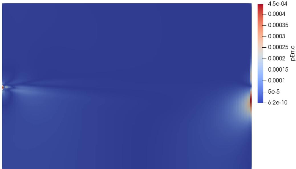
Figure 4.18: Erreur sur la pression pour l'écoulement turbulent de type couche cisailé
