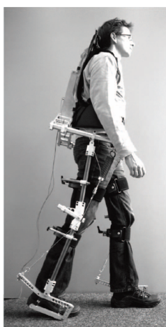
(a) Mécanisme à tendons (van Dijk et al., 2011) ©2011 IEEE
