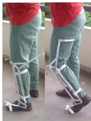
(c) Mécanisme à membrures pour la dorsiflexion (Berkelman et al., 2007) ©2007 IEEE
