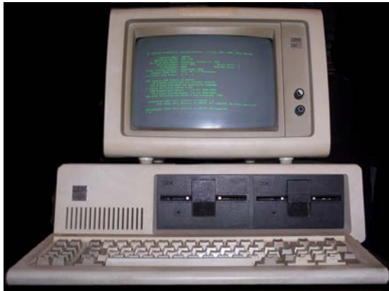
1. ábra: Az IBM PC zöld monokróm monitorral (5150) és billentyűzettel MS-DOS 5.0-t futtat
