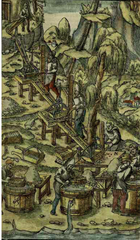
A besztercebányai rostasor (a rézérc előkészítési folyamata) a De re metallicában, 8. könyv, 149. ábra
