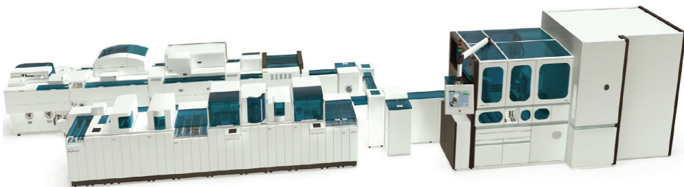
Az előtérben preanalitikai modulsor, amelyhez szállítószalaggal kapcsolódik a hátul elhelyezkedő mérőautomata sor, illetve a jobbra látható posztanalitikai berendezés. (Roche Diagnostics)
