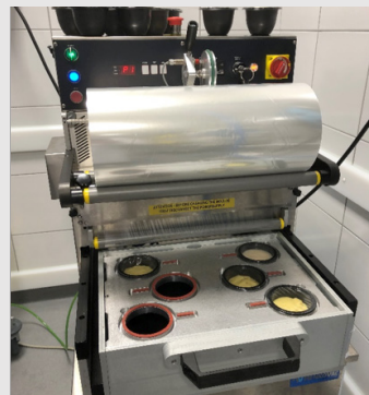
Pakkemaskine med speciallavet værktøj.
