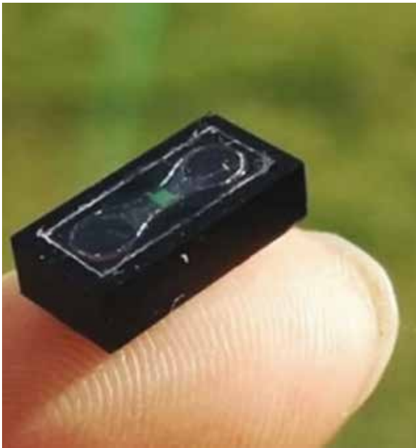
Figur 1. Sensoren kombinerer nanobrønde med en optisk bølgeleder. Den fylder mindre end en kvadratmillimeter.
