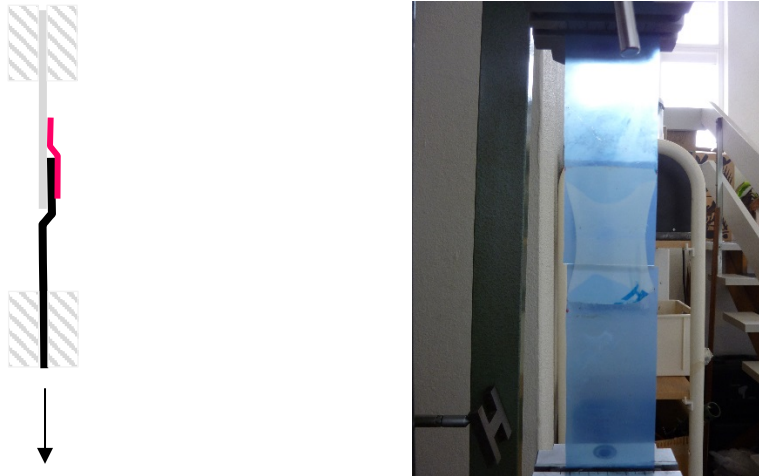
FIGUR 4. Prøvning af forskydningsstyrke på 50 mm strimler af membran klæbet i forlængelse af hinanden. Tv. Skematisk fremstilling set fra siden med tape markeret med rødt. Th. Foto af opstilling under afprøvning. Billedet er taget forfra, og det kan ses, hvordan klæberen slipper (lysere område), mens tapen udvider sig.
