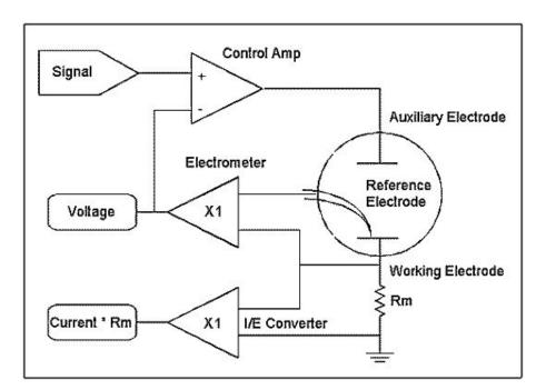
Figure 4.1: Potentiostat Schematic [28]
