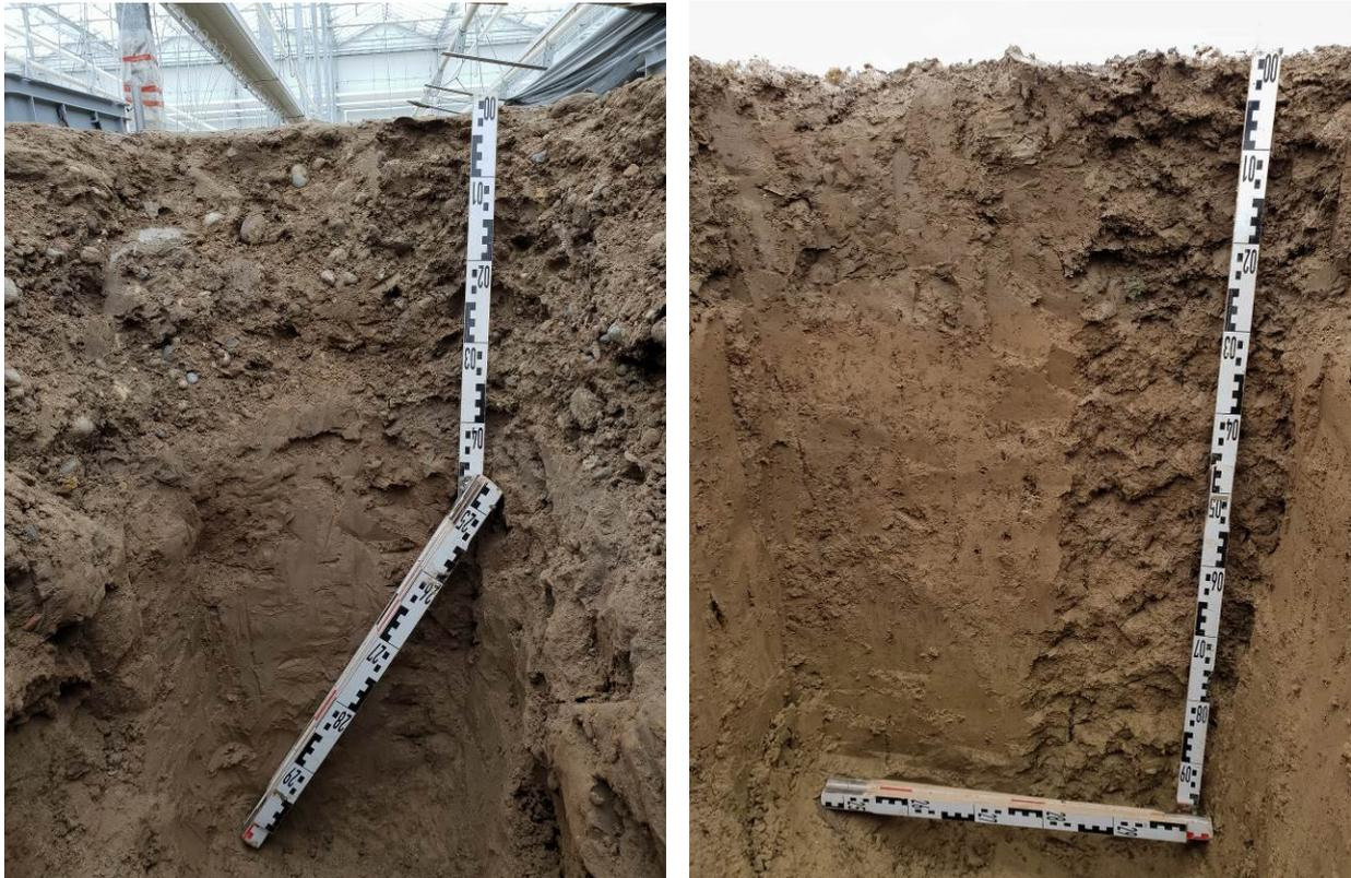
**Abbildung 3:** Bodenprofile am Standort 3. Gewächshausboden links, Boden der Referenzfläche rechts. Auf der linken Abbildung ist deutlich die Überschüttung zu sehen, die im Gewächshaus gemacht wurde.
