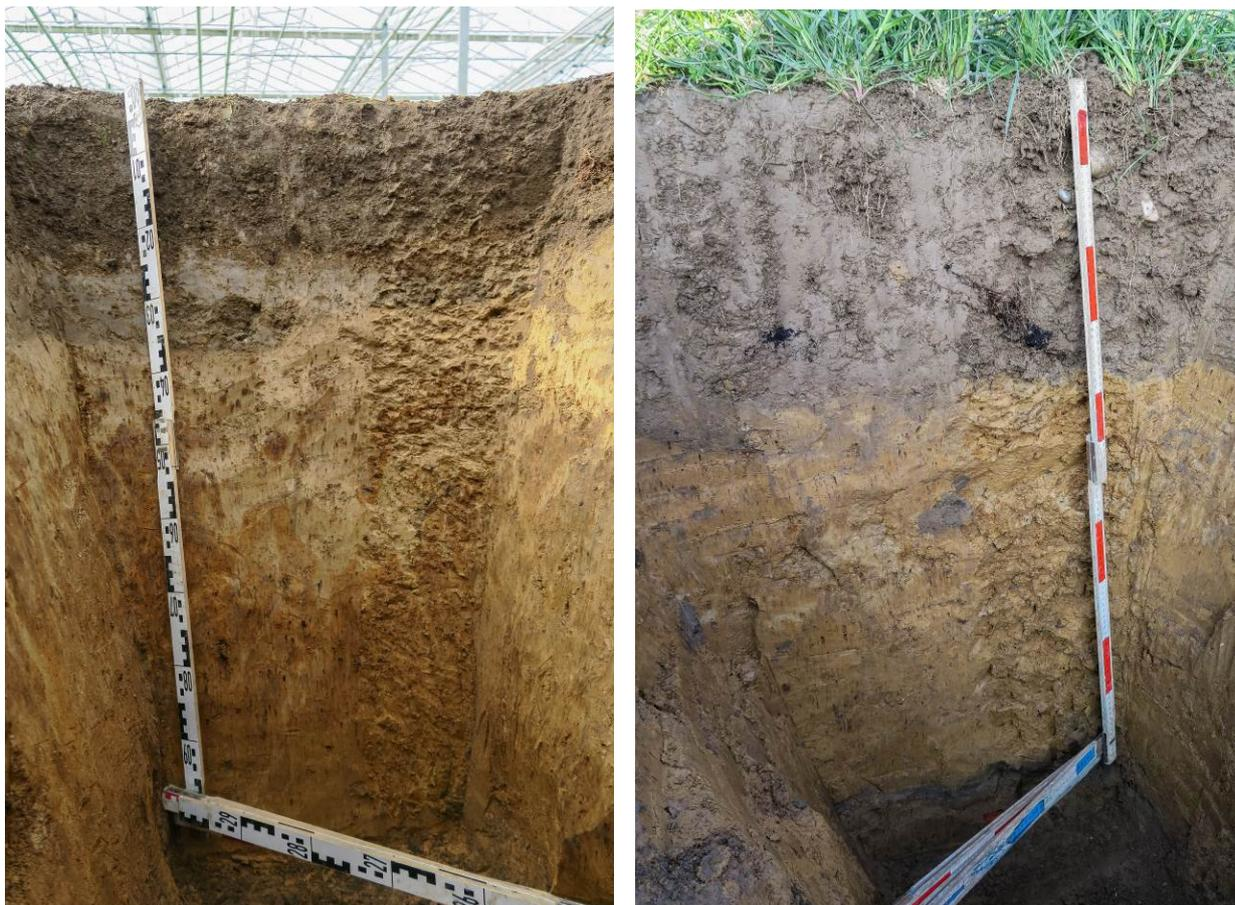
**Abbildung 4:** Bodenprofile am Standort 5. Gewächshausboden links, Boden der Referenzfläche rechts. Hier unterscheiden sich die Bodenprofile, weil im Zuge des Baus von Gewächshaus 5 auf der Referenzfläche eine Aufschüttung gemacht wurde.
