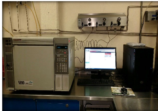
Figura 14. Fotografía del cromatógrafo de gases y ordenador con software Agilent ChemStation.
