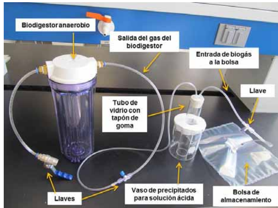
Figura 5-19 Sistema de captación de biogás acoplado al digester anaerobio
