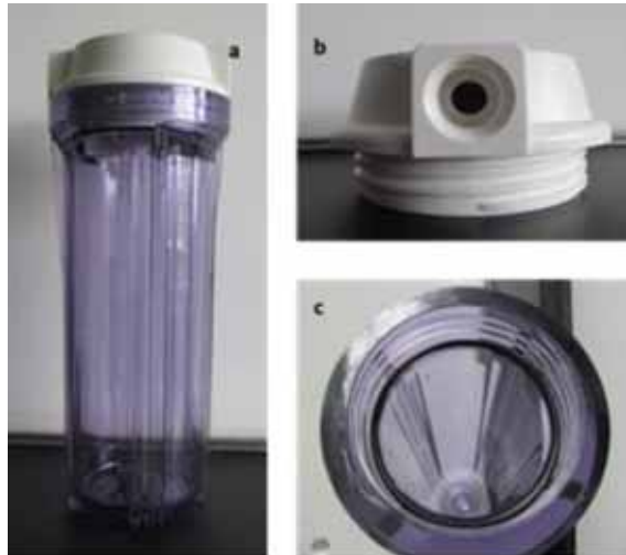
Figura 5-4 Recipiente utilizado para la construcción de los biodigestores anaerobios: a) Porta filtro, b) Tapa roscada, c) Rosca y empaque del porta filtro
