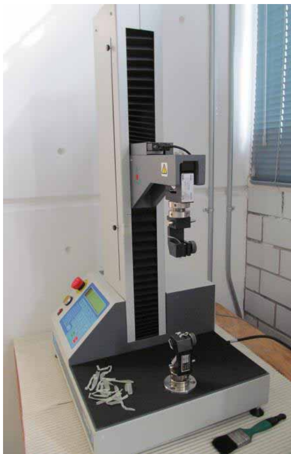
Figura 5-11 Determinación del porcentaje de elongación de las películas plásticas de interés con máquina de ensayos Lloyd LF plus
