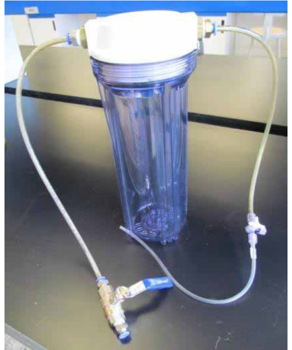
Figura 5-6 Digestor anaerobio armado
