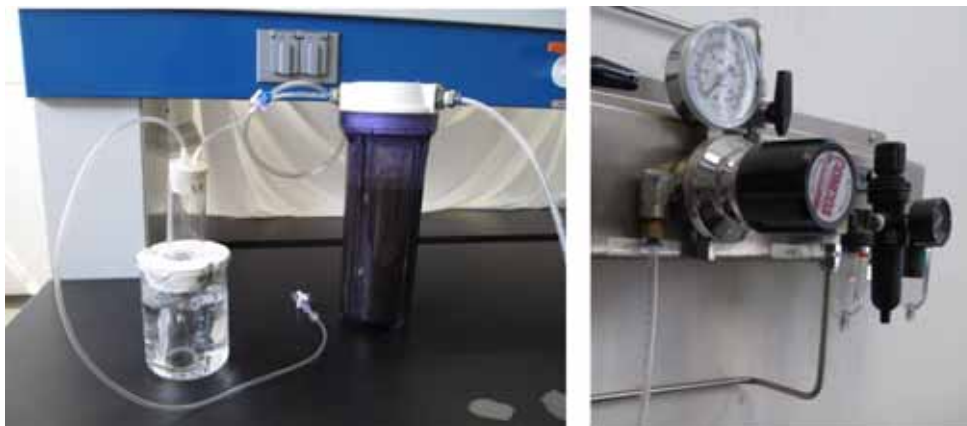
Figura 5-17 Purga de dispositivos con gas nitrógeno
