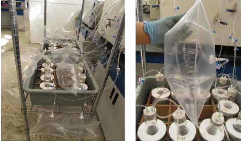
Figura 5-20 Sistema de captación de biogás
