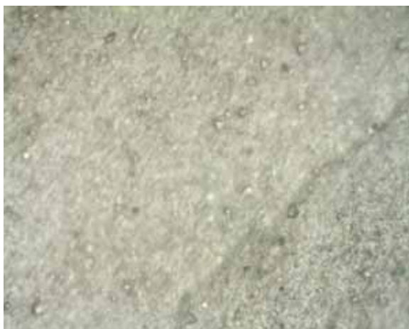
Figura 6-9 Película plástica PEAD beige antes de digestión anaerobia, aumento 40X
