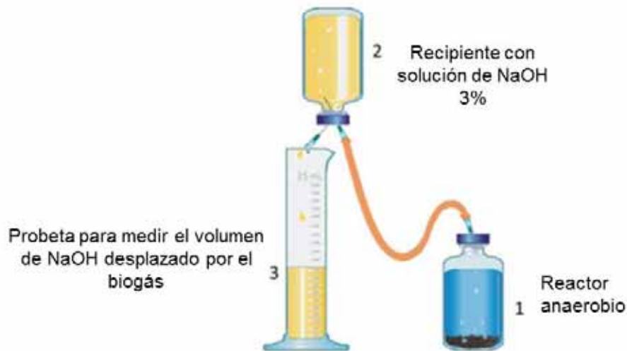
Figura 2-12 Sistema de medición de biogás a nivel laboratorio
