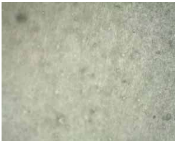
Figura 6-5 Película plástica PEAD oxodegradable oxidada antes de digestión anaerobia, aumento 40X
