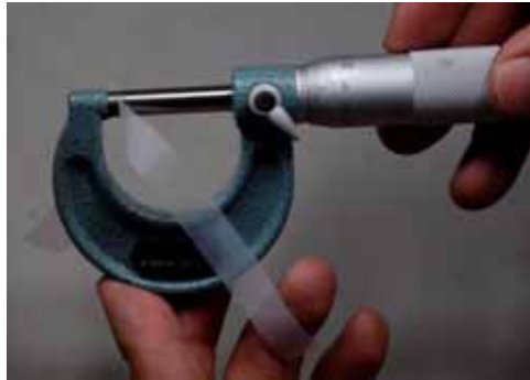
Figura 5-10 Medición de espesor de películas plásticas con micrómetro
