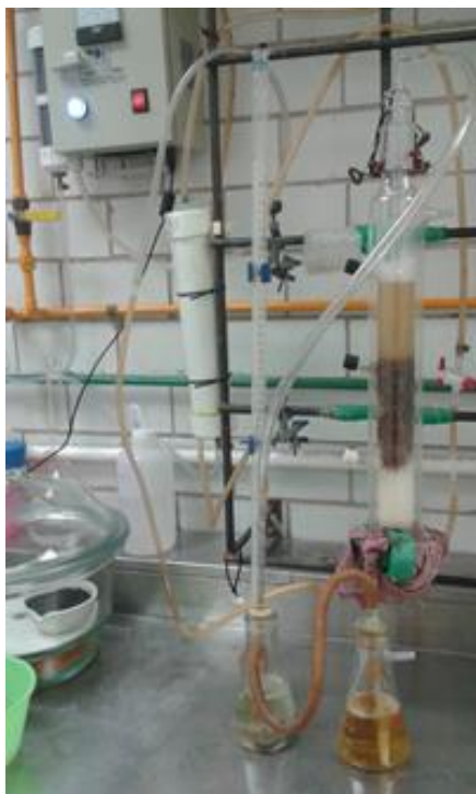
Fotografía 5. Reactor de ozonización
