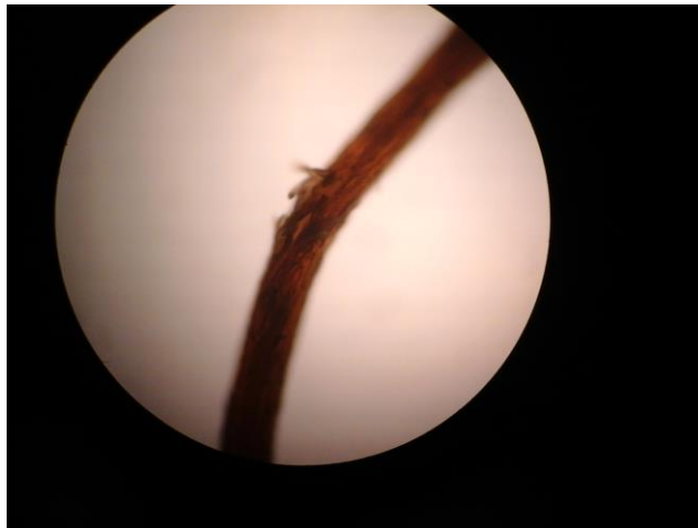
Fotografía 20. Bagazo 4 h ebullición con 25 % NaOH sin ozono (MO)
