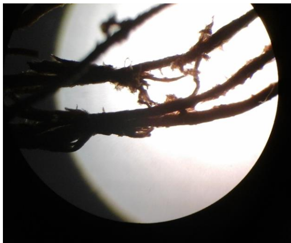
Fotografía 21. Bagazo cocción 2 h con NaOH en autoclave (MO)
