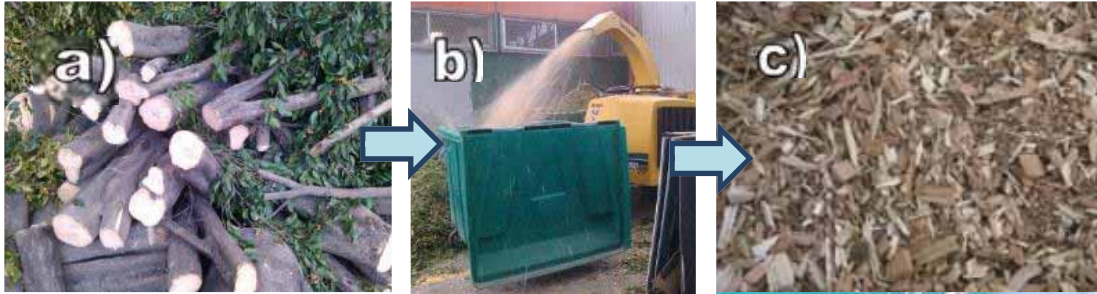
Figura 4.6 Obtención del Mulch a) Ramas generadas por poda en la universidad b) Trituradora Veermeer c) Mulch
