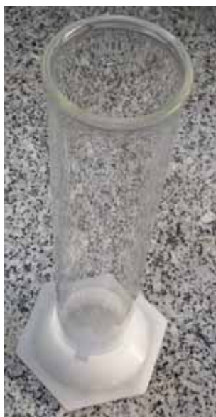
Figura 4.23 Rizotrones de vidrio de 5 cm de diámetro y 25 cm de altura, en los que se realizaron las pruebas de fitotoxicidad
