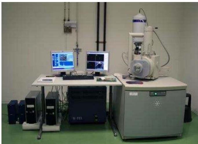
Figura 5.7 Microscopio electrónico de barrido de bajo vacío, marca: JEOL, modelo: JSM-5900 LV.
