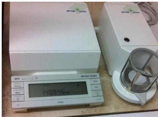
Figura 24. Microbalanza utilizada para filtros de 47mm de teflón (max 5.1g,  $d=1\mu\text{g}$ ).
