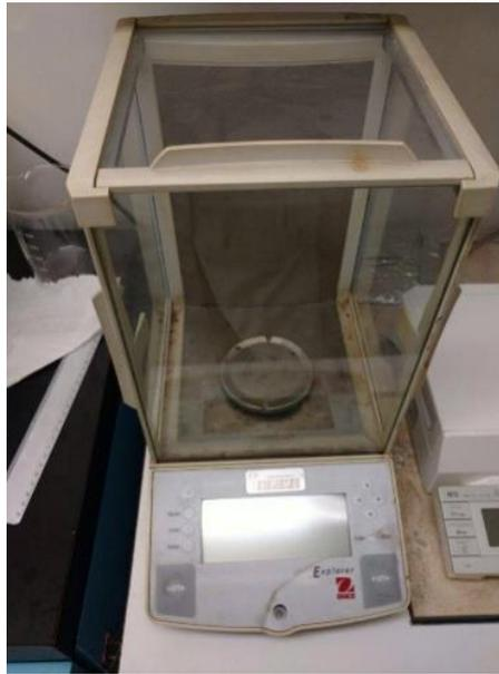
Figura 23. Balanza utilizada para filtros de cuarzo (max 210g,  $d=0.1\text{mg}$ ).
