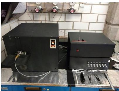
Figura 29. Equipo SUNSET LABORATORY para determinar Carbón Orgánico y elemental.
