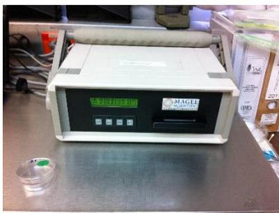
Figura 30. Equipo Óptico SootScan para la medición de carbono orgánico y carbono negro.
