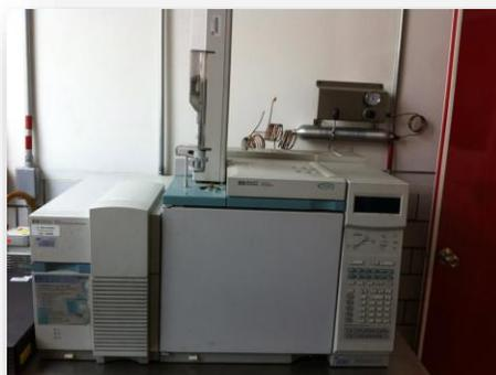
Figura 28. CG acoplado a un EM de masas HP 5973.
