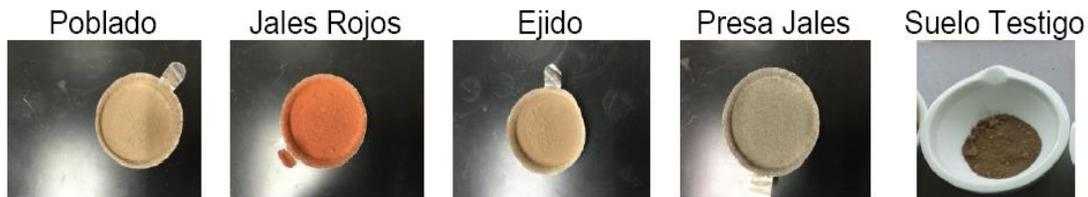
**Figura 5.1. Muestras secadas y tamizadas listas para su comparación con las tablas.**
