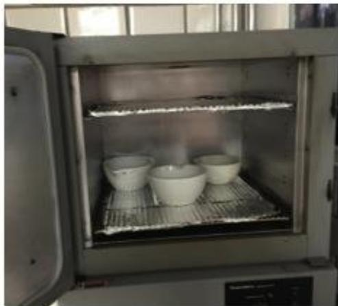
Figura 4.14. Secado de muestras para la determinación de la humedad.
