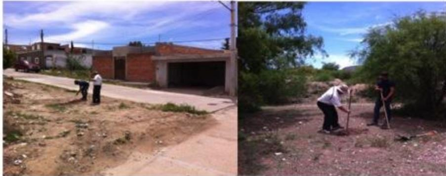
**Figura 4.3. Obtención de las muestras de suelo en diferentes partes del área de estudio.**
