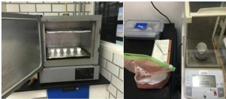
Figura B.1. Determinación de la humedad
