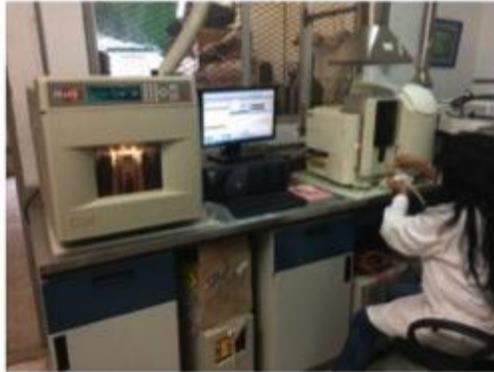
Figura 4.24. Lectura de metales mediante flama por AA.
