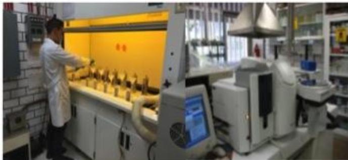
**Figura 4.23. Preparación de las muestras y equipo de AA ThermoElemental, modelo SOLAAR M6 para la lectura de las muestras**
