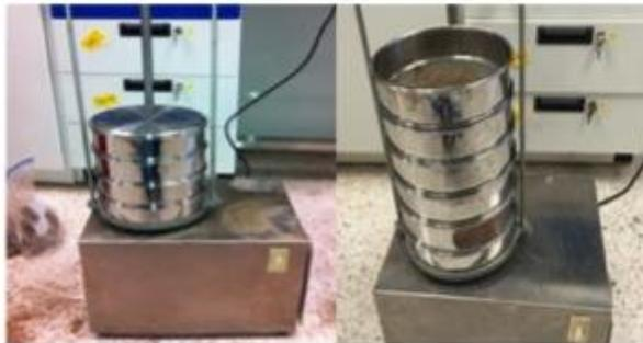
**Figura 4.8. Cribado de las muestras mediante tamices Tyler**
