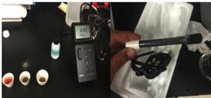
**Figura 4.17. Determinación de Conductividad Eléctrica**
