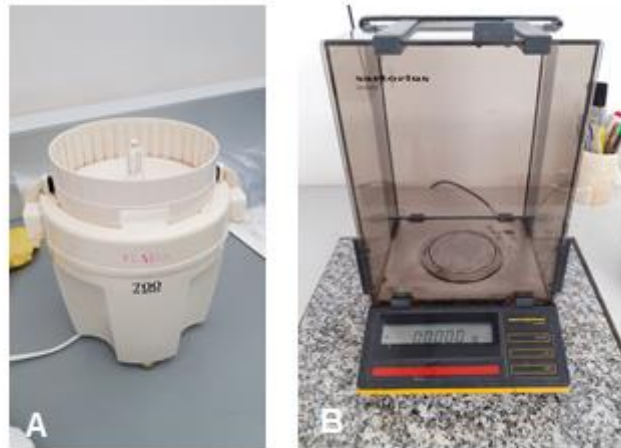
Figura 5: A- Picadora elétrica Flama; B- Balança com resolução de 0,001g, Sartorius analytic.
