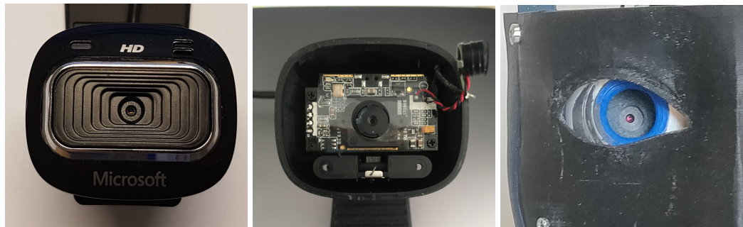
Kuva 4. Microsoft LifeCam HD-3000 web-kamera alkuperäisessä kuoressaan, purettuna ja asennettuna InMoov-robotin silmään.
