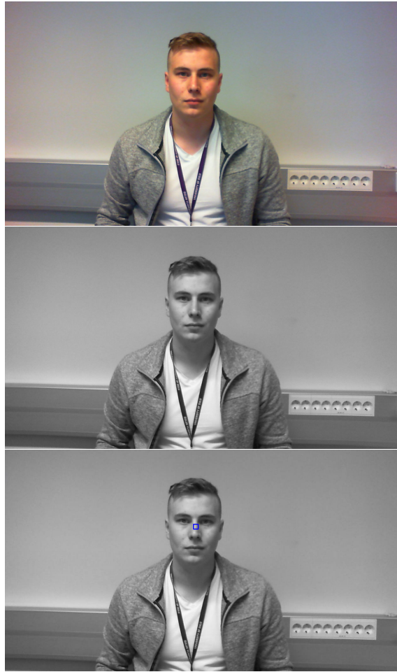
Kuva 9. Esimerkki kasvontunnistuksen toteutuksesta, kun kasvot ovat 1 metrin päässä kamerasta. Ylimmässä alkuperäinen kuva. Keskimmäisenä kuva mustavalkomuunnoksen jälkeen ja alimpana kuva, josta kasvontunnistajan antamiin koordinaatteihin on piirretty sininen neliö.
