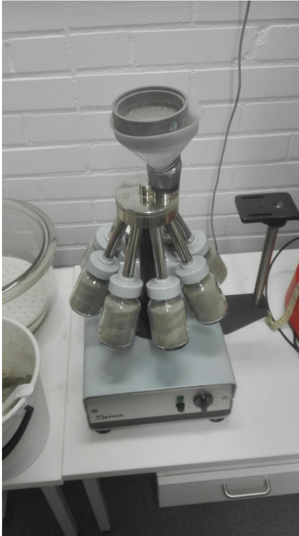
Kuva 5. 3. rikastushiekkakerroksesta otetun näytteen kahtiointia. (Juutinen, 2018)
