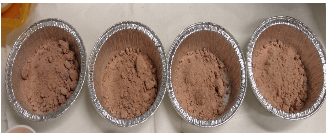
Kuva 8. 1 dl näyte 1050 °C:n lämpökäsittelyn jälkeen.
