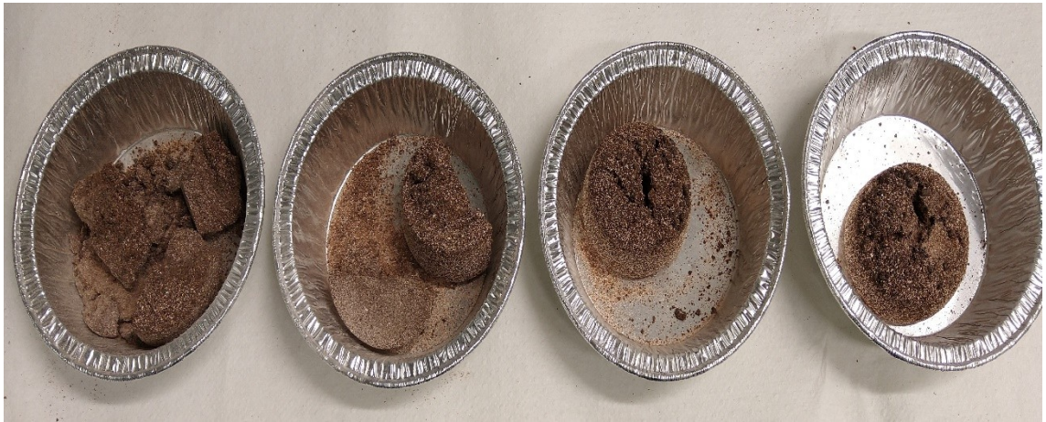
Kuva 10. 1 dl näyte 1150 °C:n lämpökäsittelyn jälkeen.
