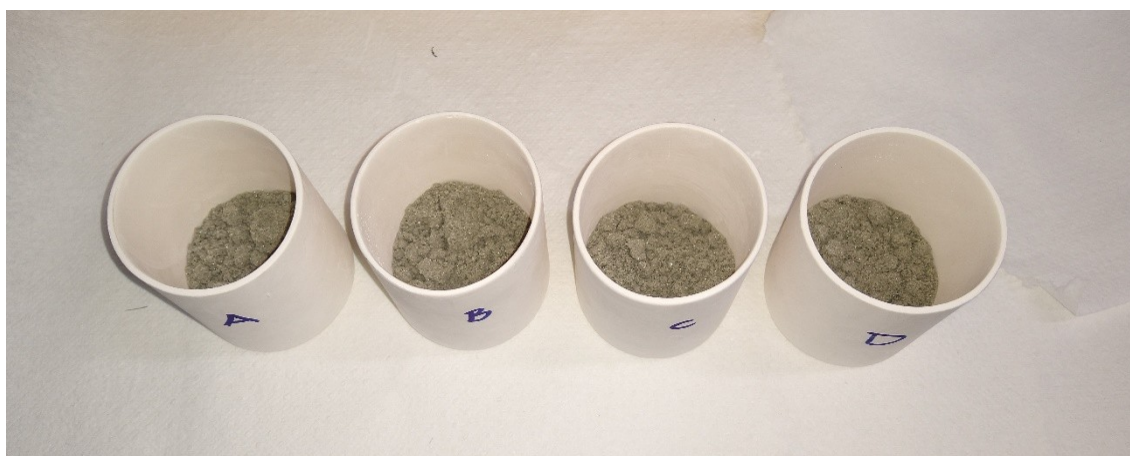
Kuva 4. Esikäsitelty 1050 °C:n 1 dl:n näyte valmiina uuniin.
