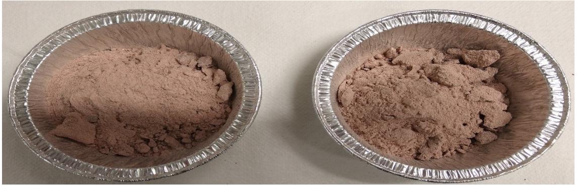
Kuva 9. 0,5 dl näyte 1075 °C:n lämpökäsittelyn jälkeen.
