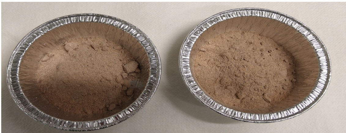
Kuva 6. 0,5 dl näyte 950 °C:n lämpökäsittelyn jälkeen.
