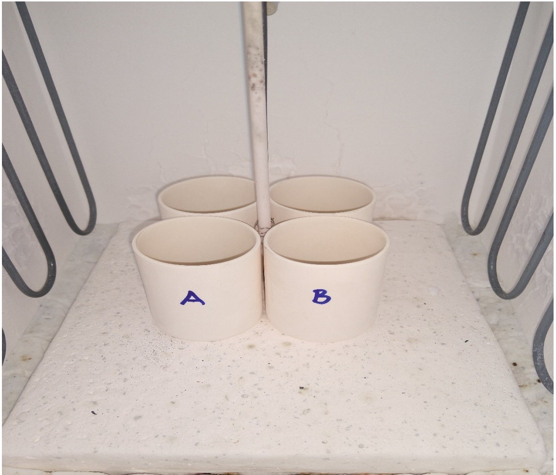
Kuva 5. Aloksiupokkaiden asettelu 1050 °C:n lämpökäsittelyä varten.
