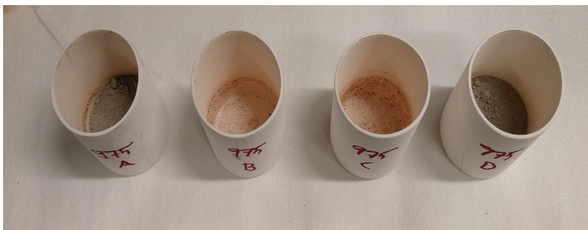
Kuva 3. Esikäsitelty 975 °C:n 0,5 dl:n näyte valmiina uuniin.
