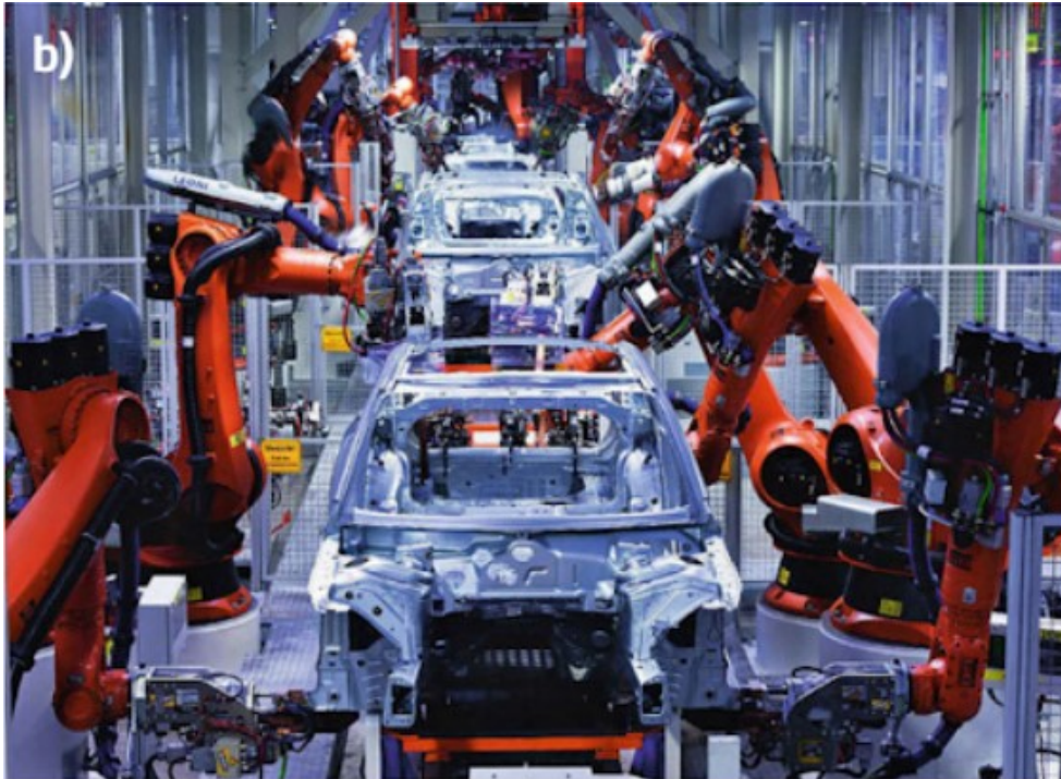
Kuva 9. Autoteollisuuden linjasto (Siciliano & Khatib 2016, s. 1396) (Kuva julkaistaan Springer:in luvalla.)
