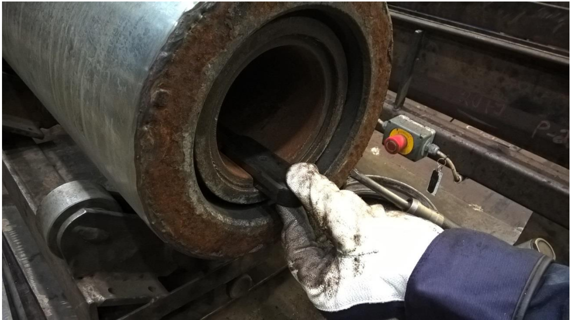
Kuva 42. Sovitetaan kiilaa vaipan kiilauralle.
