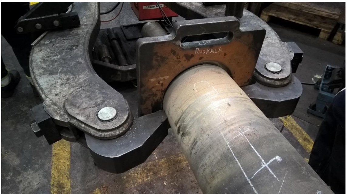
Kuva 7. Ulosvetoraudan ja ulosvetolaitteen asento.
