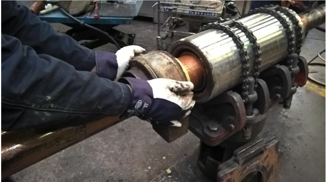
Kuva 51. Asennetaan keskilaakeripesät hyvin rasvatuille akseliholkeille.
