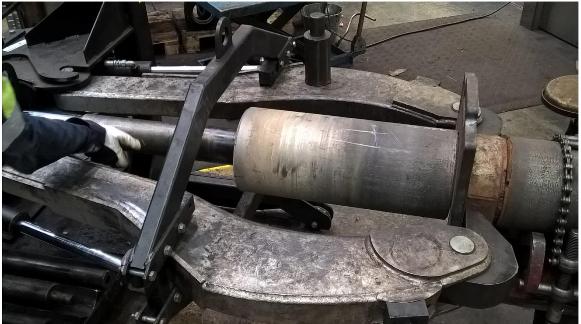
Kuva 8. Asetetaan vetorauta vaipan taakse, vetolaite raudan taakse, vetolaitteen mäntä akselin pään kohdalle ja nostetaan paineet vetolaitteen tunkkiin.
