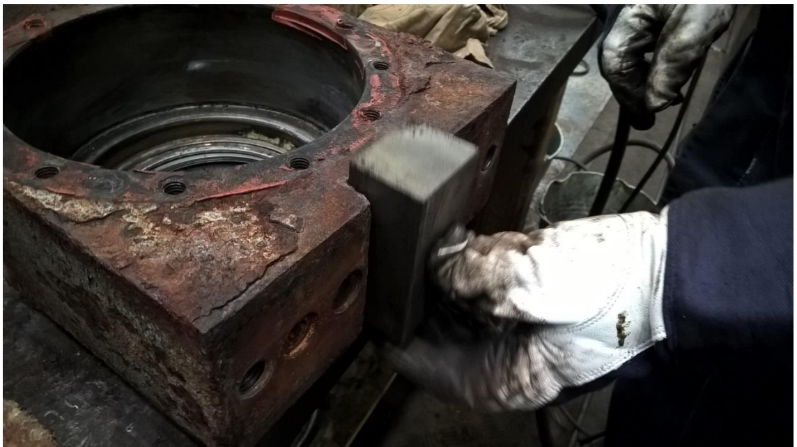
Kuva 25. Testataan kiilojen liikkuminen kiilaurissaan.
