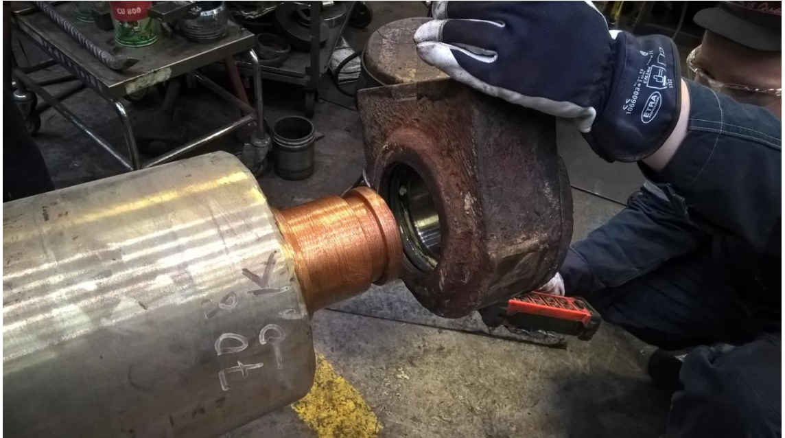
Kuva 55. Päätypesät laitetaan heti vaippojen perään.
