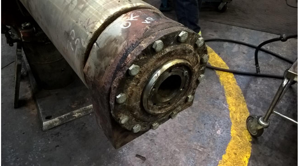
Kuva 62. Päätykansi asennetaan paikoilleen.
