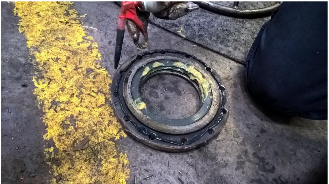
Kuva 61. Laakeripesän kannen tiivistysmassan levitys.
