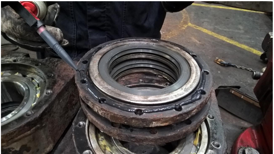
Kuva 35. Pursotetaan tiivistemassa pesän kannen tiivistepinnalle.
