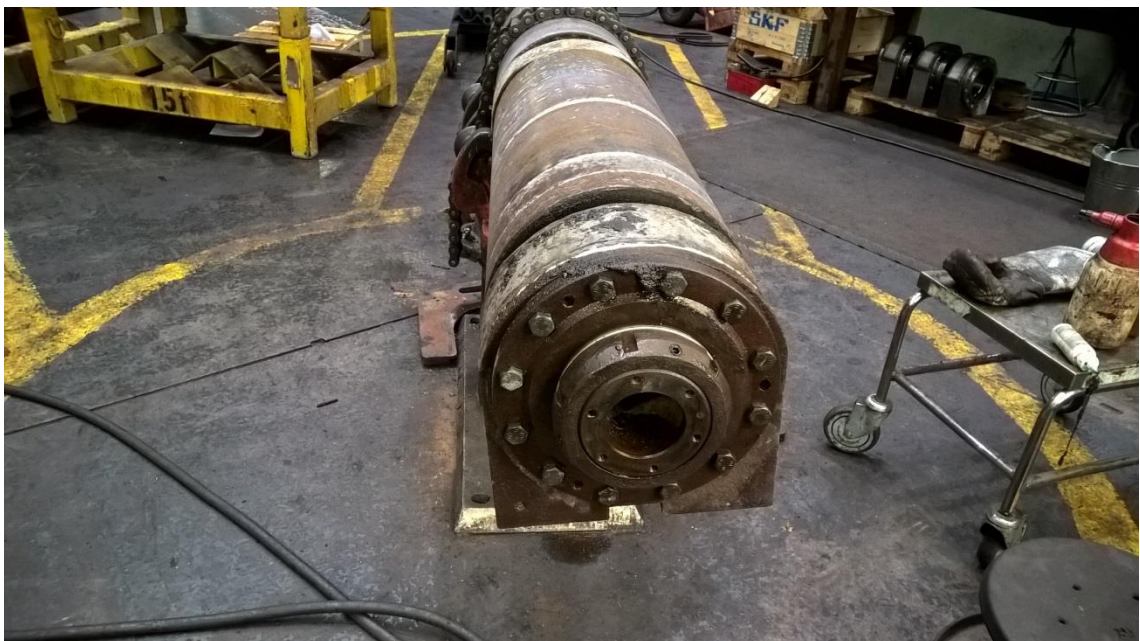
Kuva 1. Kiinnitetään rulla huoltotelineeseen.
