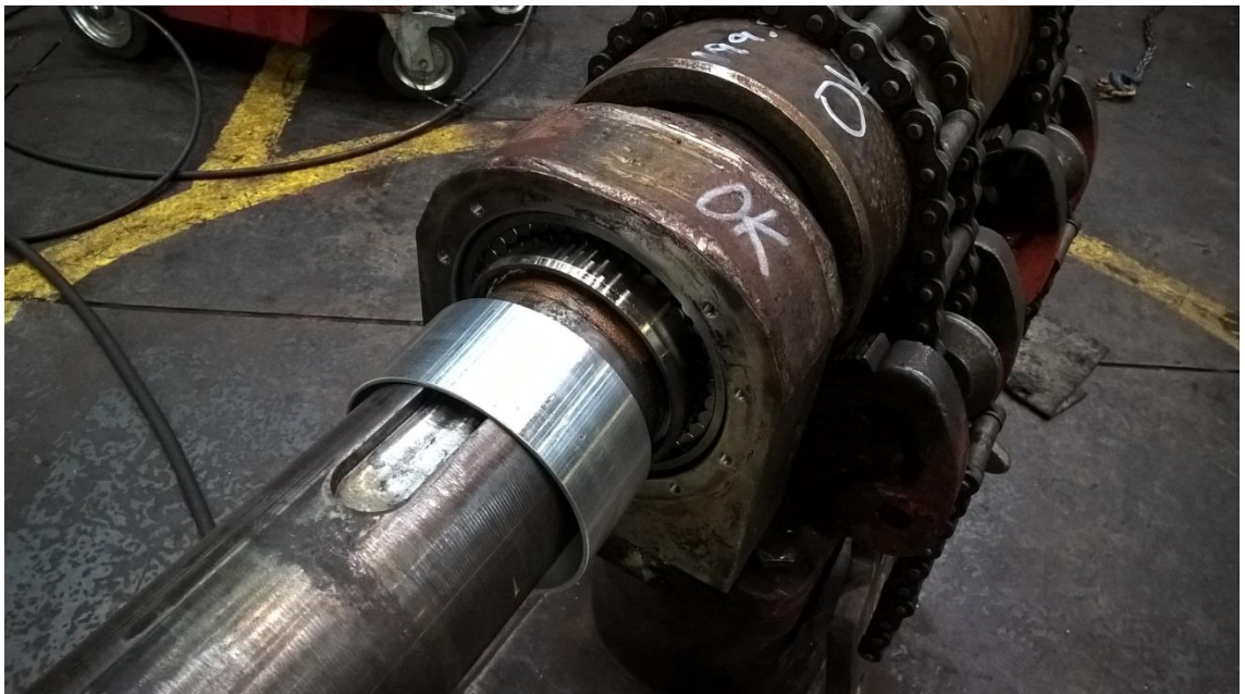
Kuva 70. Laakeripesä on paikoillaan, ja holkki sen edellä on tippunut pois.
