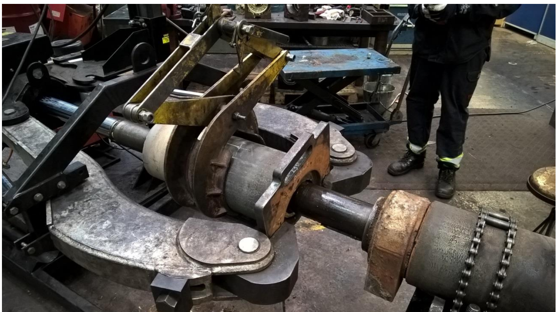
Kuva 10. Vaippa nytkähtää liikkeelle, ja se otetaan kiinni nosturisaksilla.
