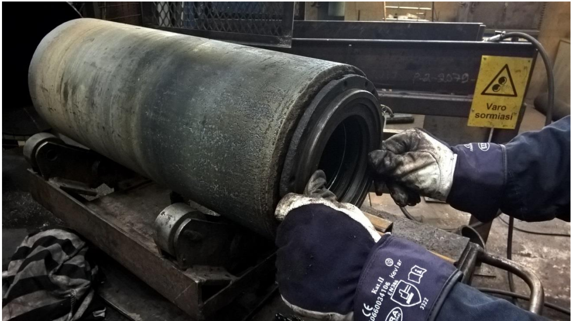
Kuva 41. Kokeillaan pyörittää laakeripesän kantta vaipan sisällä. Sen tulisi pyöriä vapaasti.
