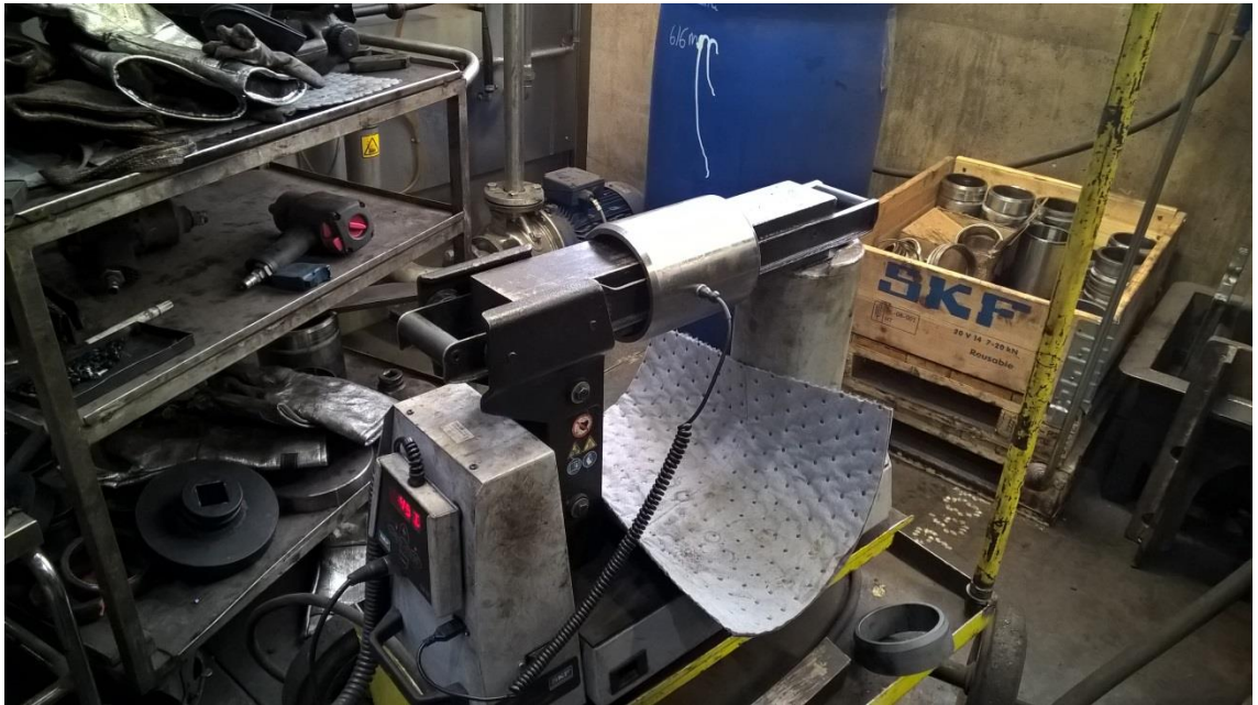
Kuva 49. Akseliholkin lämmitys induktio-/laakerilämmittimellä.
