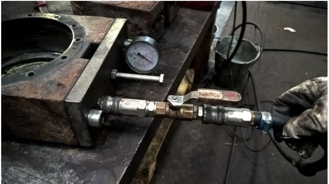
Kuva 28. Kiinnitetään ponnistuslevy pesään ja aukaistaan hana.
