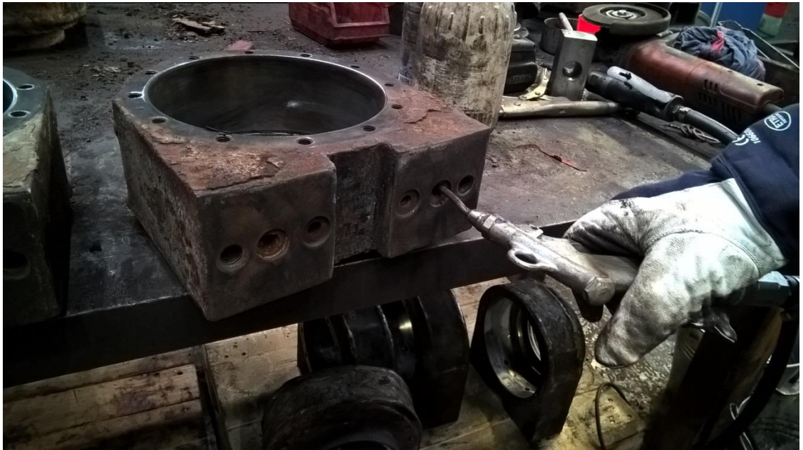
Kuva 27. Vesikanavan aukaisu paineilmalla.
