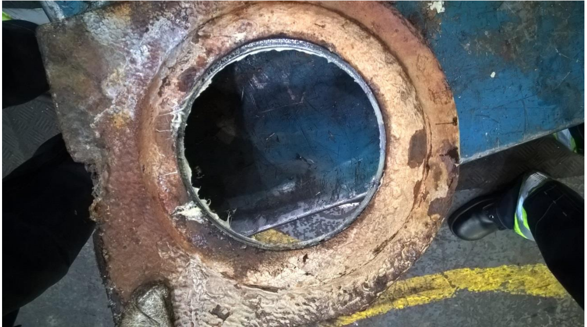
Kuva 72. Soikeaksi kulunut pesän ura.
