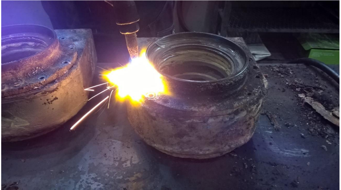
Kuva 18. Laippojen pulttien irrotusta pultteja lämpimänä käyttämällä.
