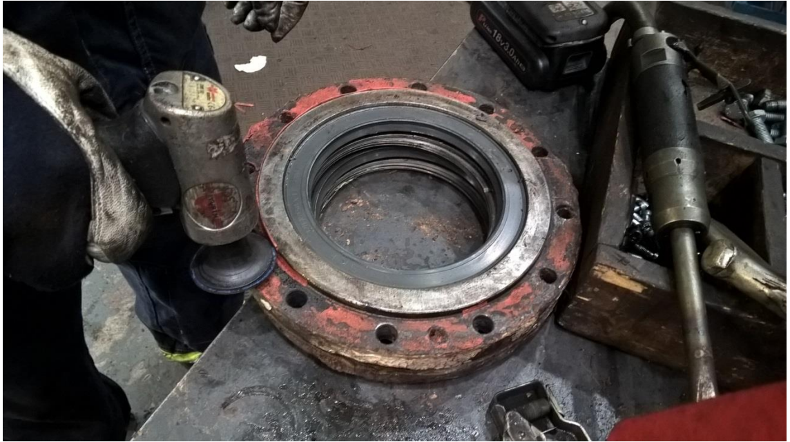
Kuva 33. Hiotaan pesien kansien tiivistepinnat puhtaaksi.
