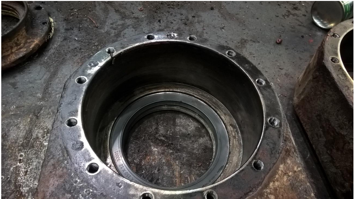
Kuva 32. Myös laakeripesän kanteen, jota ei tarvinnut irrottaa, painetaan tiiviste tunkilla.
