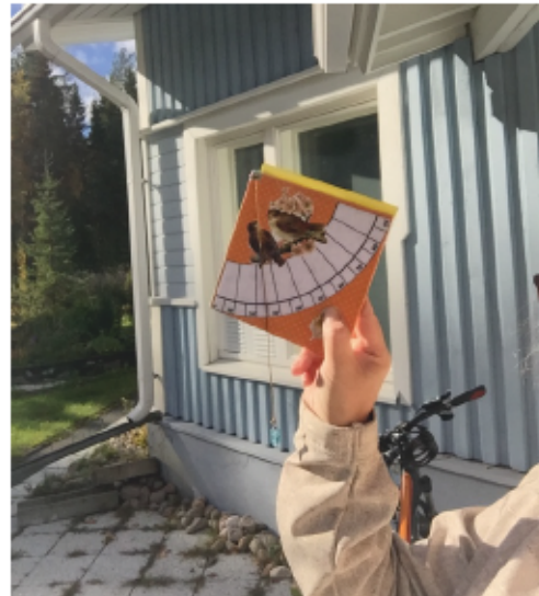
Kuva 22. Leveysasteen mittaus - kvadrantti mehupillistä ja peltilevyn palasta. Kuva ja kvadrantti Susanna Kuokkanen.
