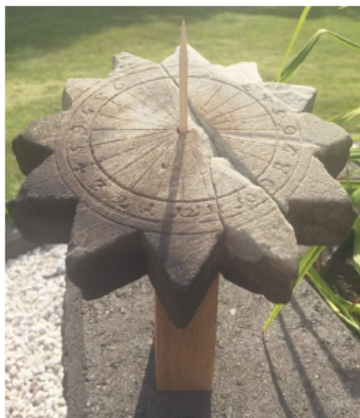
Kuva 12. Ekvatoriaalinen Tornion kello näyttää paikallista aurinkoaikaa n. klo 12.20. Kello asennettuna Kiimingin Alakylän mukaan, 25 aseteen kulmaan 16.8.2018 klo 13.34. Suomen valtionaikaa. Kuva ja asennus Susanna Kuokkanen.
