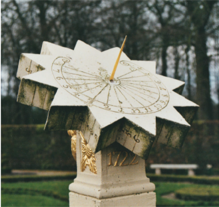
Kuva 33. Menkemaborgin tähtiaurinkokello. Kuvassa näkyy sakaroiden numerointi sisäkulmissa sekä sakaranumeroinnin sijoittuminen tuntiviivan päälle. Kuva on vuodelta 2000, nykyisin kellossa on kullatut numerot. Kuva Frans Maes.
