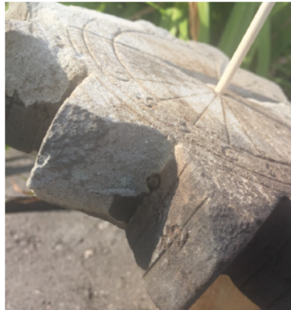
Kuva 13. Kello on 12 aurinkoaikaan. Vauriot sakaroissa vaikuttavat varjon paikkaan eli kellon osoittamaan aikaan. Sakaroiden paksuus ja pituus määrittää ajannäytön osumisen oikeaan kohtaan sakaran asteikolla. Kuva Susanna Kuokkanen.
