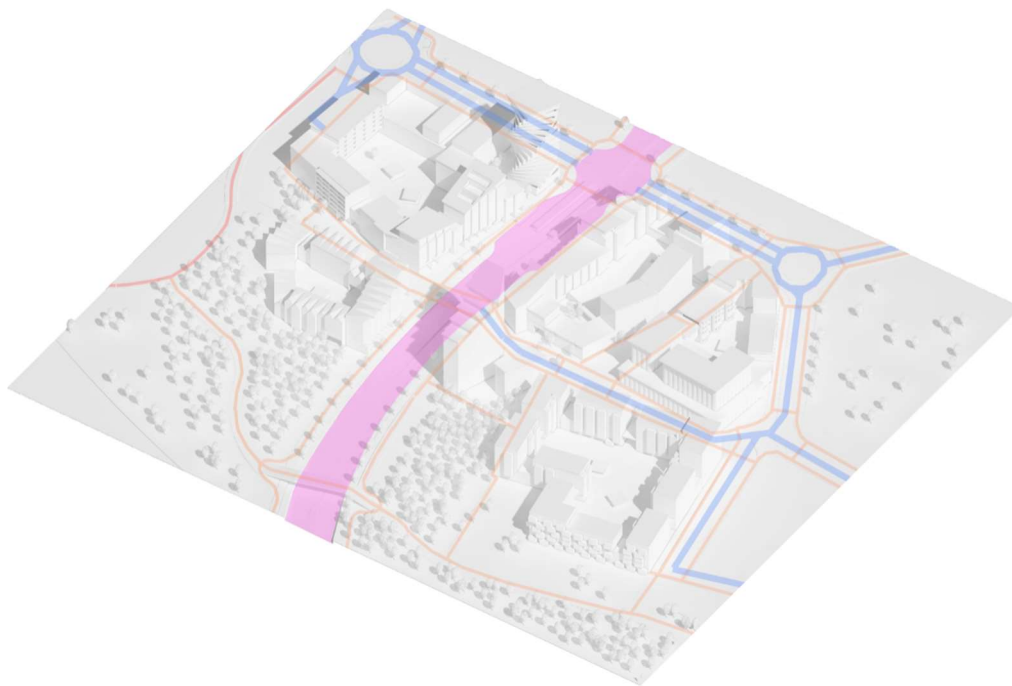
Kuva 52. Reittikaavio osoittaa bulevardin (vaaleanpunainen), ajoneuvoliikenteen (sininen), kevyenliikenteen (oranssi) ja pyöräbaanan (punainen) väylät suunnittelualueella. Bulevardilla kulkee 2+2 autokaistat ja 1+1 bussikaista. (Tekijän kuva).
