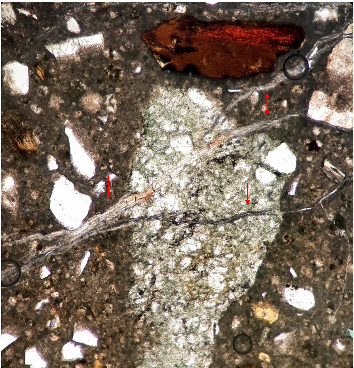
Kuva 9. Alkalikiviainesreaktion aiheuttamaa säröilyä betonissa. Reaktion seurauksena on muodostunut geeliä, joka on paisunut ja aiheuttanut painetta betoniin. Tämän seurauksena on muodostunut suhteellisen voimakasta säröilyä, joka leikkaa kiviainetta. Säröissä on täytteenä alkalipiigeeliä. Säröt ovat osoitettu kuvassa nuolin. Kuvan pidemmän sivun pituus luonnossa on noin 2 mm. (Kuva Antti Autere)
