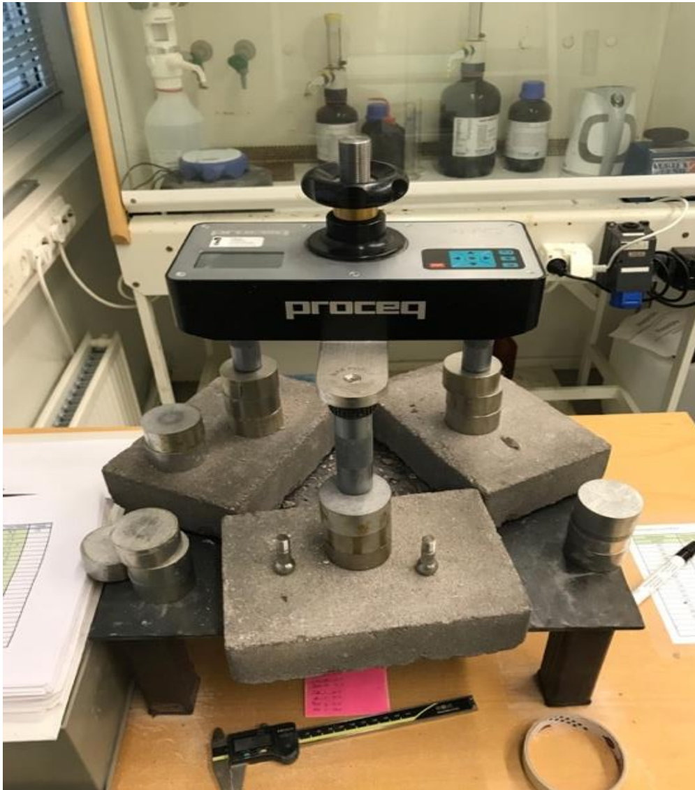
Kuva 22. Vetolujuuskoeistus voidaan suorittaa kuvanmukaisella laitteella. (Kuva Antti Autere)
