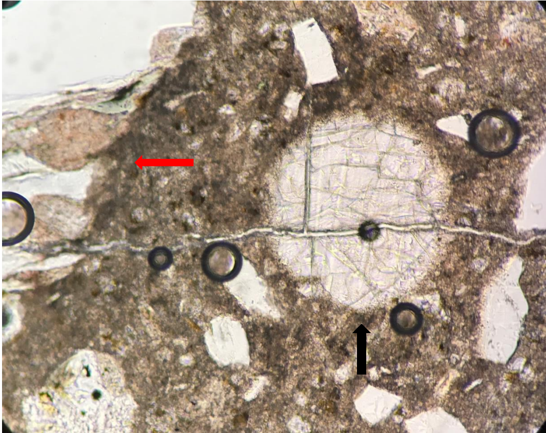
Kuva 11. Reagoanut kiviainekappale (merkitty punaisella nuolella) vasemmalla, josta alkaa mikrosärö. Reaktiotuote, eli alkalipiigeeli, on virrannut mikrosäröä pitkin huokoseen (merkitty mustalla nuolella) ja täyttänyt sen. Mikrosärö jatkuu huokosen läpi. Kuvan leveys luonnossa on noin 2 mm. (Kuva Antti Autere)
