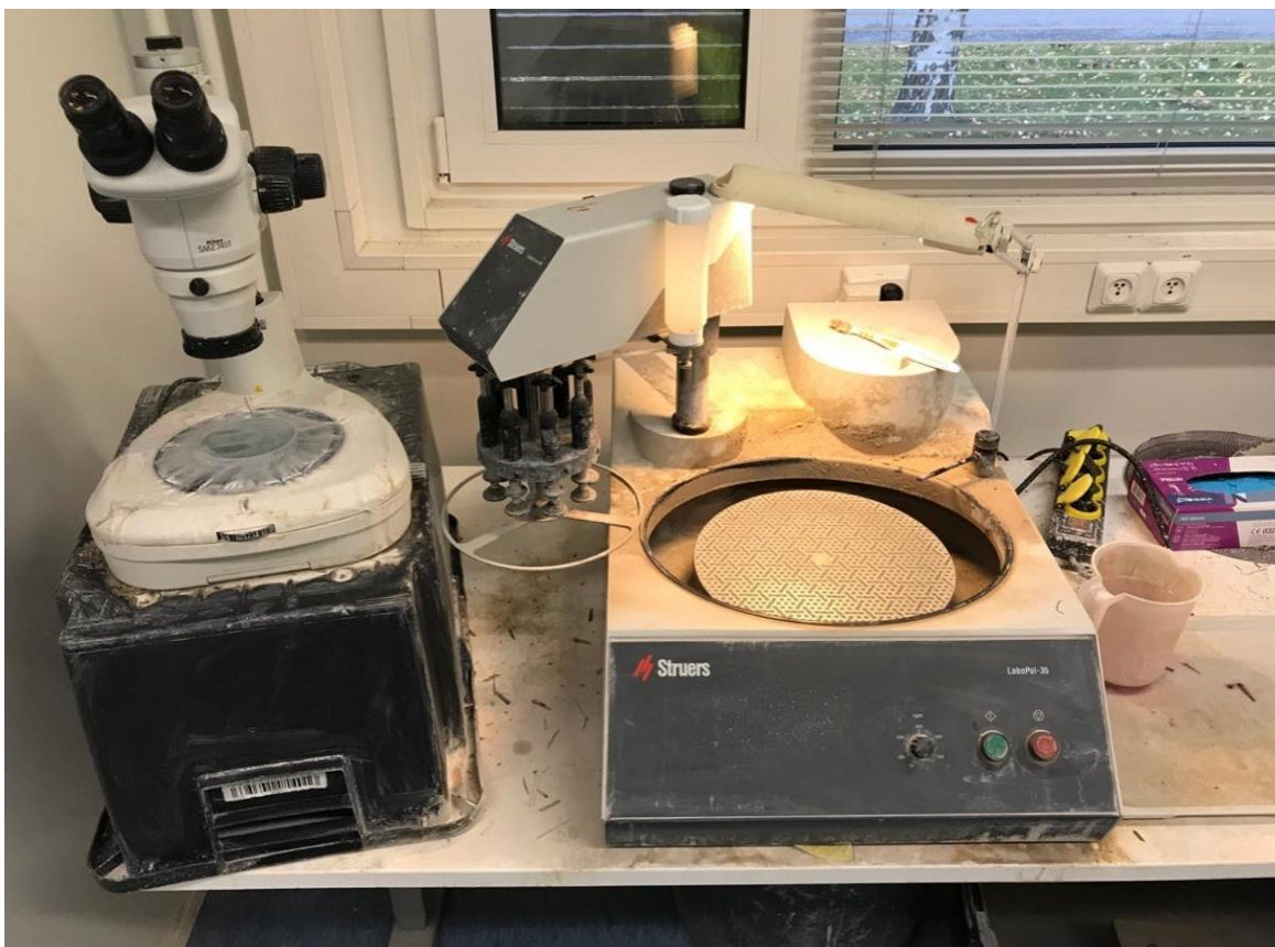
Kuva 23. Ohuthienäyte ohennetaan käsin hiomalla 0,02 mm paksuiseksi. Ohennusvaiheessa käytetään karkeudeltaan 220 mesh vesihionta-alustaa ja hieen paksuutta tarkkaillaan mikroskoopilla. (Kuva Antti Autere)
