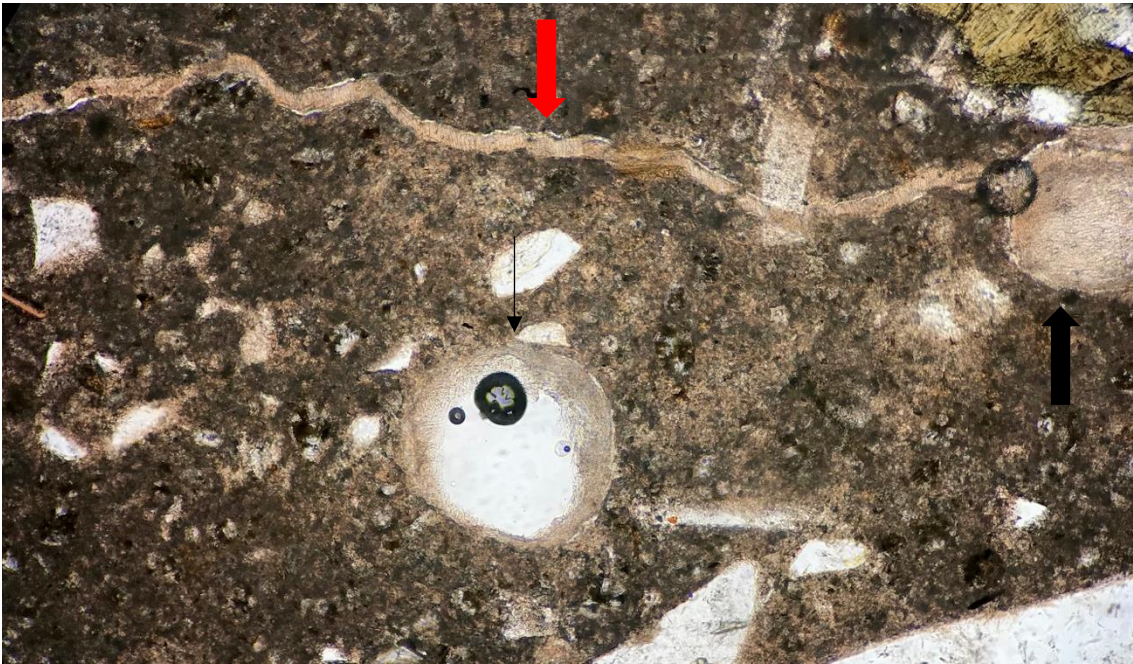
Kuva 5. Pakkasrapautumisen aiheuttama pinnansuuntainen särö. Huokonen (merkitty paksummalla mustalla nuolella) ja sen lävistävä särö (merkitty punaisella nuolella) ovat täyttyneet ettringiitillä. Kuvassa keskellä olevan huokosen seinämille on kiteytynyt ettringiittiä (merkitty mustalla nuolella). Kuvan leveys luonnossa on noin 2 mm. (Kuva Antti Autere)
