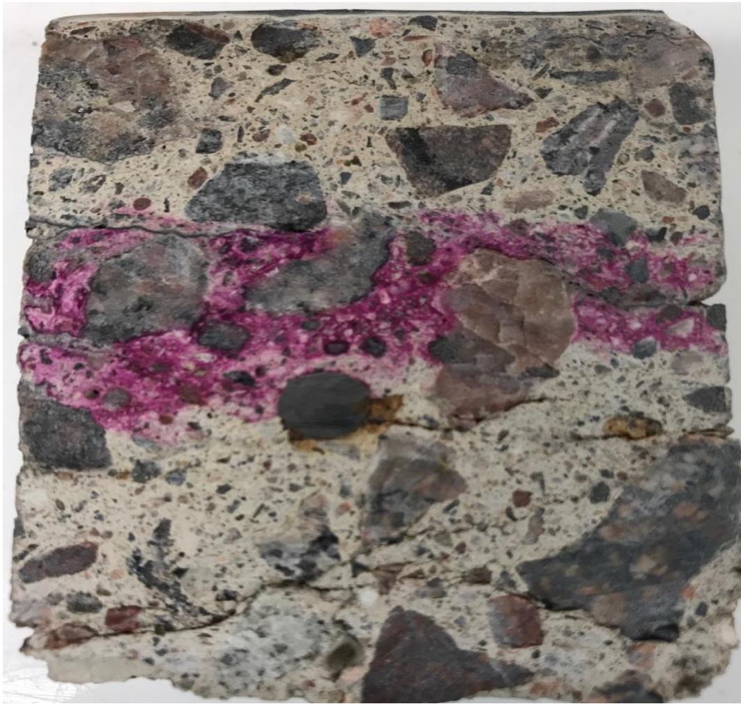
Kuva 19. Karbonatisoitumissyvyyden määrittäminen halkaistusta poralieriöstä fenoliftaleiiniliuoksella. Karbonatisoituneessa vyöhykkeessä ei tapahdu värimuutoksia, kun taas karbonatisoitumaton vyöhyke värjäytyy punaiseksi. Kappaleessa pinnansuuntainen säröily on pakkasrapautuman aiheuttamaa. Näytteen leveys on 45 mm. (Kuva Antti Autere)
