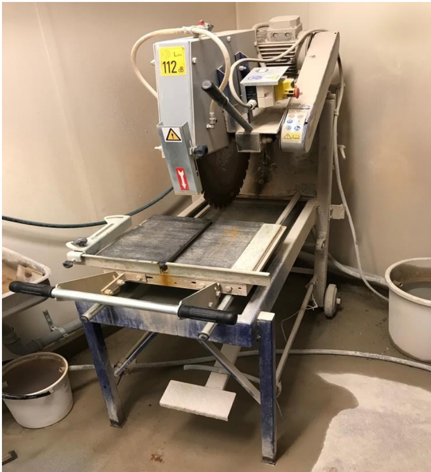
Kuva 21. Betonilieriö halkaistaan pituussuunnassa timanttisahalla. Lieriön halkaisun jälkeen toinen lieriönpuolikas pestään ja kuivataan pinta. Kuivuneelle pinnalle suihkutetaan fenoliftaleiini karbonatisoitumissyvyyden määrittämiseksi. (Kuva Antti Autere)
