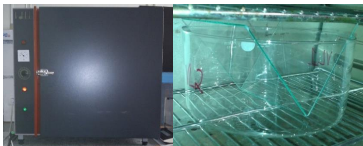
Figura 25: Substratos de vidro (lisos) durante a secagem (após a etapa de imersão em KOH).
