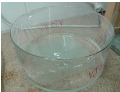
Figura 24: Substratos de vidro (jateados) imersos na solução de KOH.
