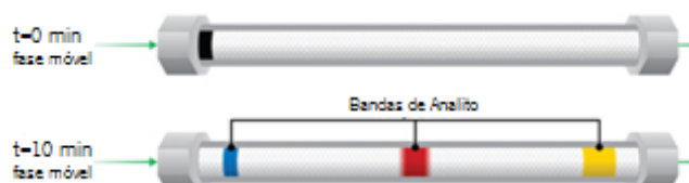
Figura 13: Separação cromatográfica de uma determinada amostra nos respetivos analitos [76].
