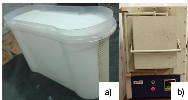
Figura 26: Equipamentos utilizados para a funcionalização de substratos de vidro: a) dip-coating ; b) forno.
