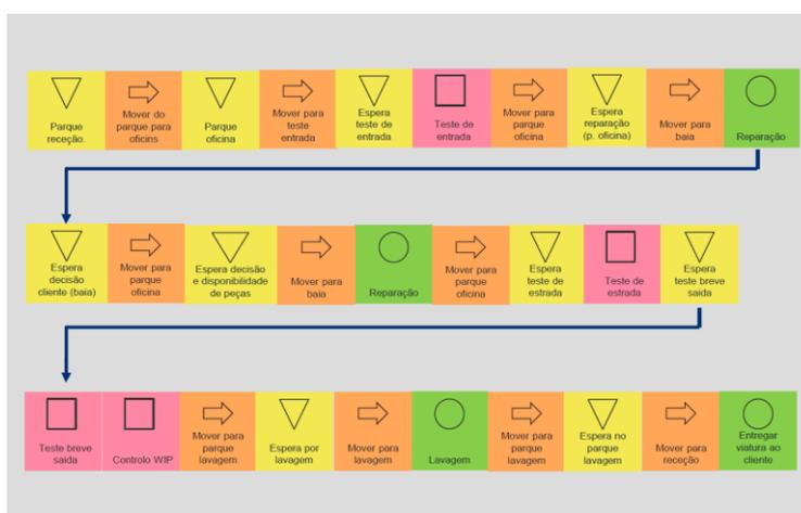
Figura 24 – VSM do fluxo de processo do APV
