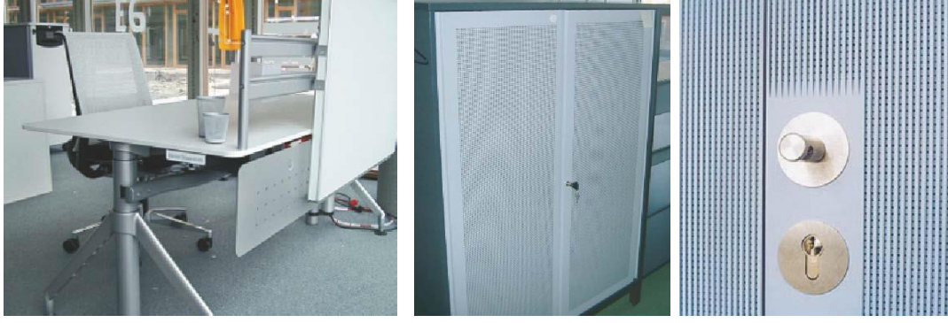
Şekil 5.7: Ofis mekanında akustik kontrol yüzeyleriyle donatı ve mobilya kullanımı örneği
