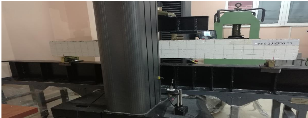
Şekil 5. Eğilme deneyi test düzeneği
