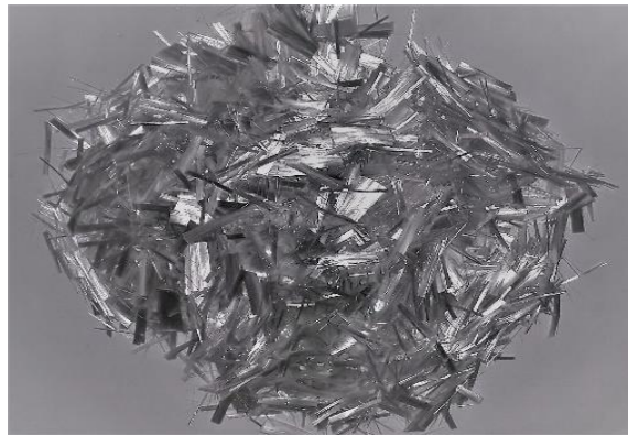
Şekil 1. Boyu 12 mm ve çapı 13 µm olan cam elyaf
