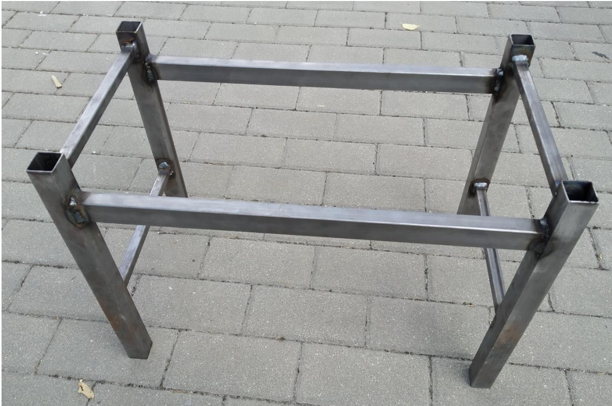
Figura 2-20. Fotografía de la estructura soldada
