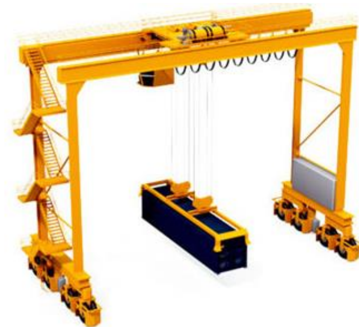
Figura 2-1. Ejemplo de morfología de una grúa pórtico.
