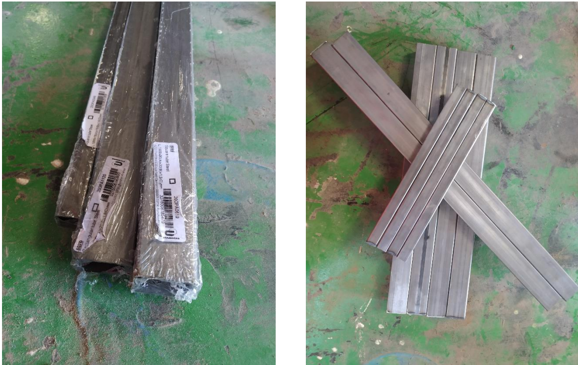
Figura 2-16. Perfiles comerciales comprados y piezas cortadas a las medidas requeridas.
