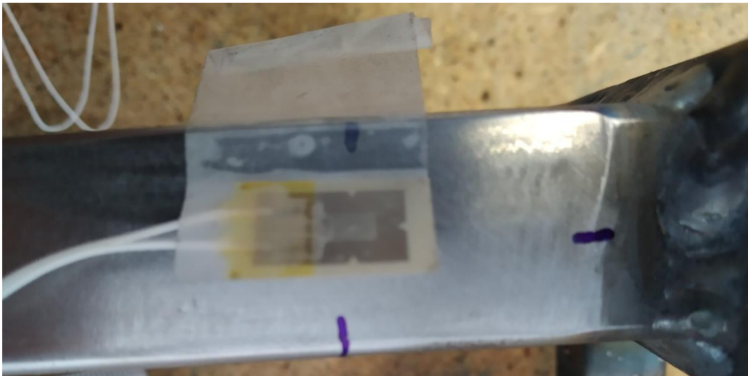
Figura 3-5. Posicionamiento de la galga previo al pegado.
