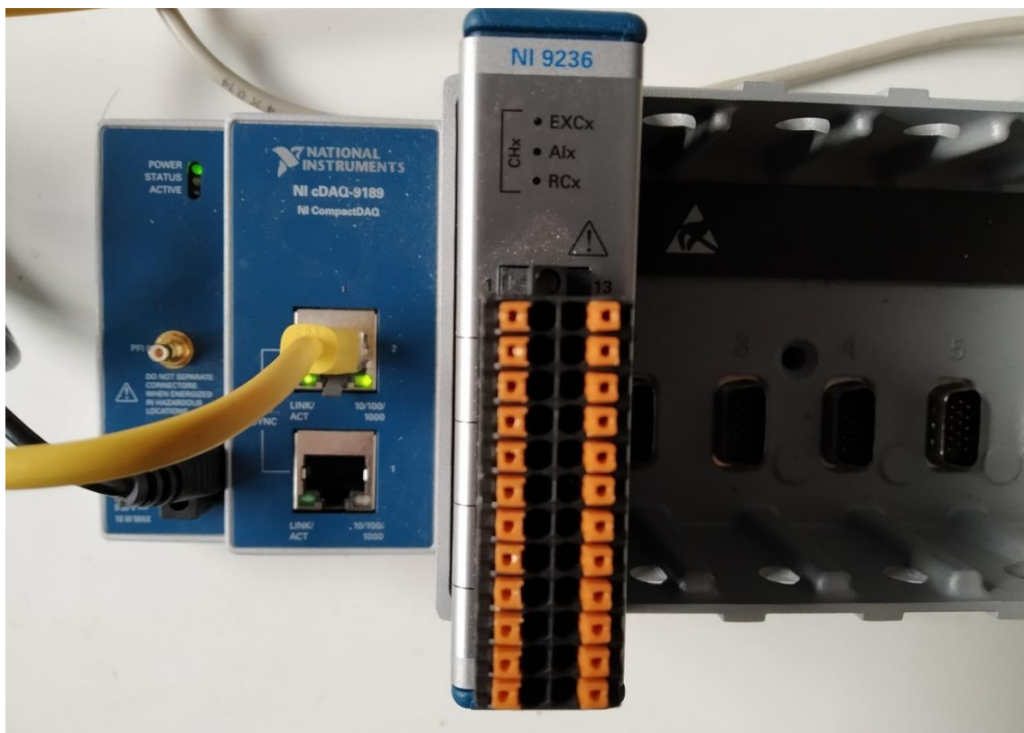
Figura 3-10. Sistema adquirente de datos de los sensores.
