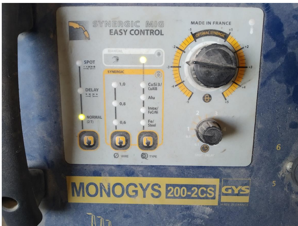
Figura 2-17. Equipo de soldadura MIG utilizado para el proceso de soldeo de la estructura.
