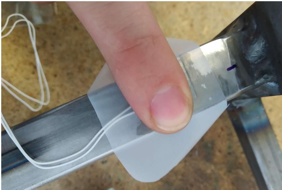
Figura 3-7. Aprisionamiento con el dedo durante el secado del adhesivo.
