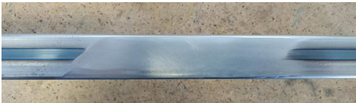
Figura 3-4. Lijado de superficie de ubicación de la galga.
