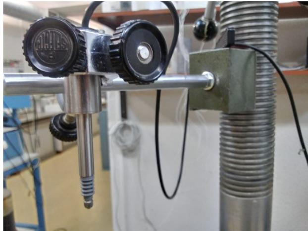
Figura 11. Transductor de desplazamiento con fijación magnético a prensa para el ensayo.
