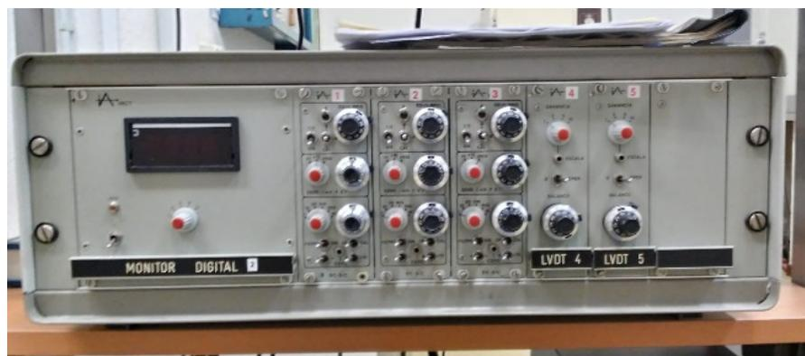
Figura 12. Equipo de acondicionador de frecuencia.
