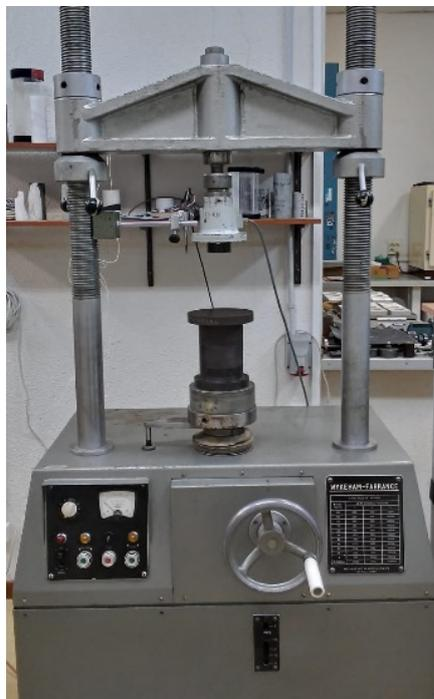
Figura 10. Prensa hidráulica, con celular de 30 [T]
