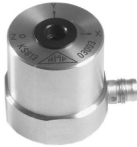
Figura 33 Acelerómetro triaxial, su funcionamiento se sustenta en variaciones de capacidad de un condensador.
