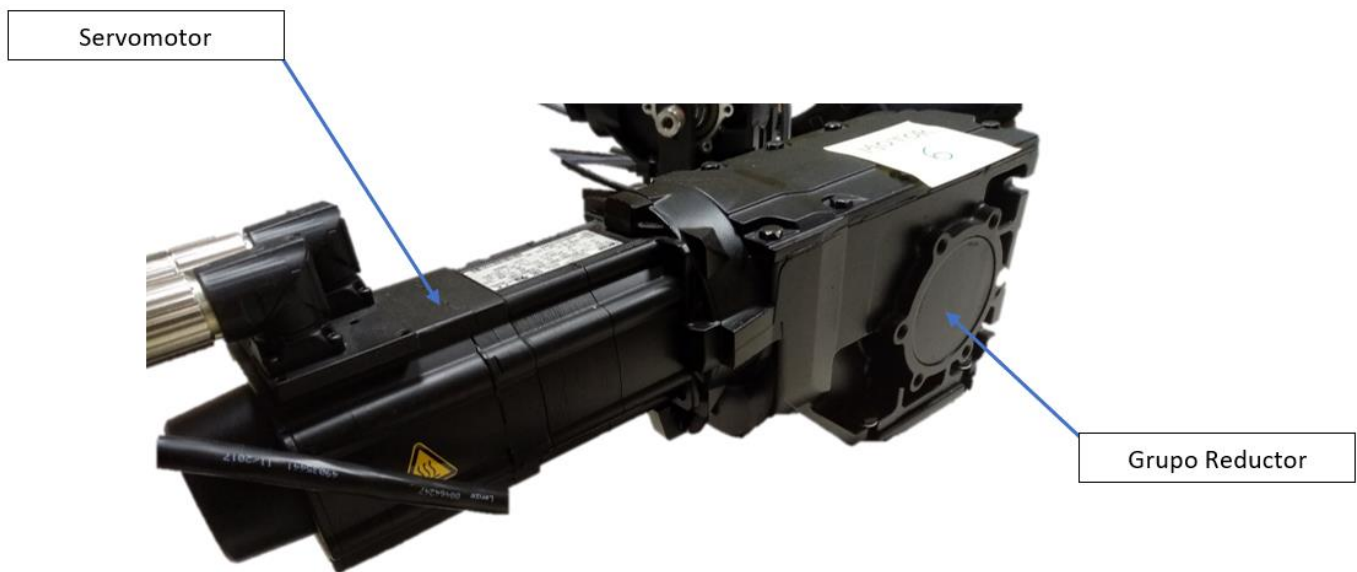
Figura 64 Servomotor y grupo reductor de la plataforma.
