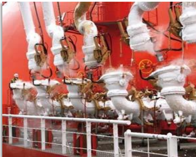
Imagen 17: Sistema de acoplamientos PERC en acción, desconexión inmediata de los brazos de carga del manifold del buque. Fuente: Bdmariner (38) .
