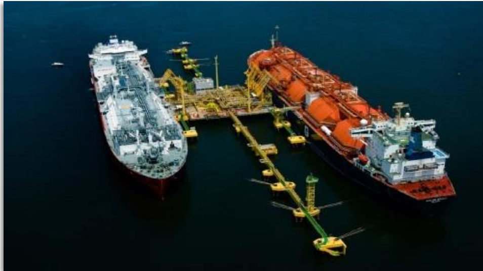
Imagen 13: Buque FSRU “Golar Spirit” recibiendo carga de otro buque LNG mediante el uso de un jetty-island de doble muelle. Fuente: Golar LNG.
