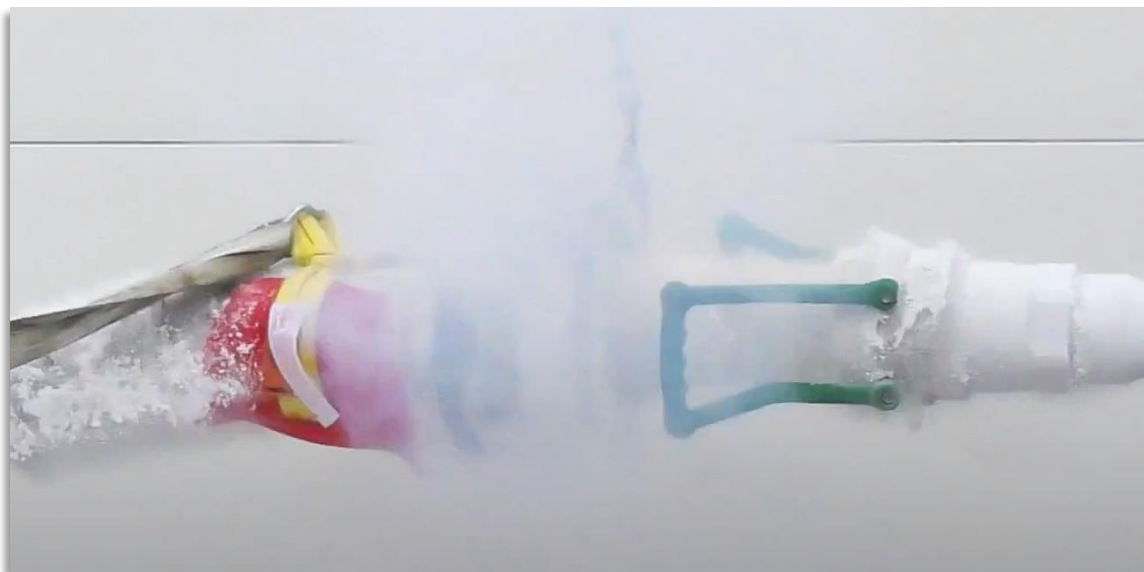
Imagen 18: Sistema de acoplamiento PERC en acción en mangueras criogénicas de transferencia de LNG. Fuente: Manntek Solutions (39)
