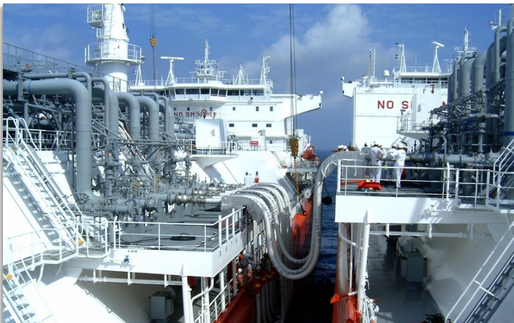
Imagen 15: Operación de aligeramiento entre dos buques LNG utilizando mangueras criogénicas como elemento de transferencia conectadas a los manifolds. Fuente: Gutteling Composite Hoses (37)
