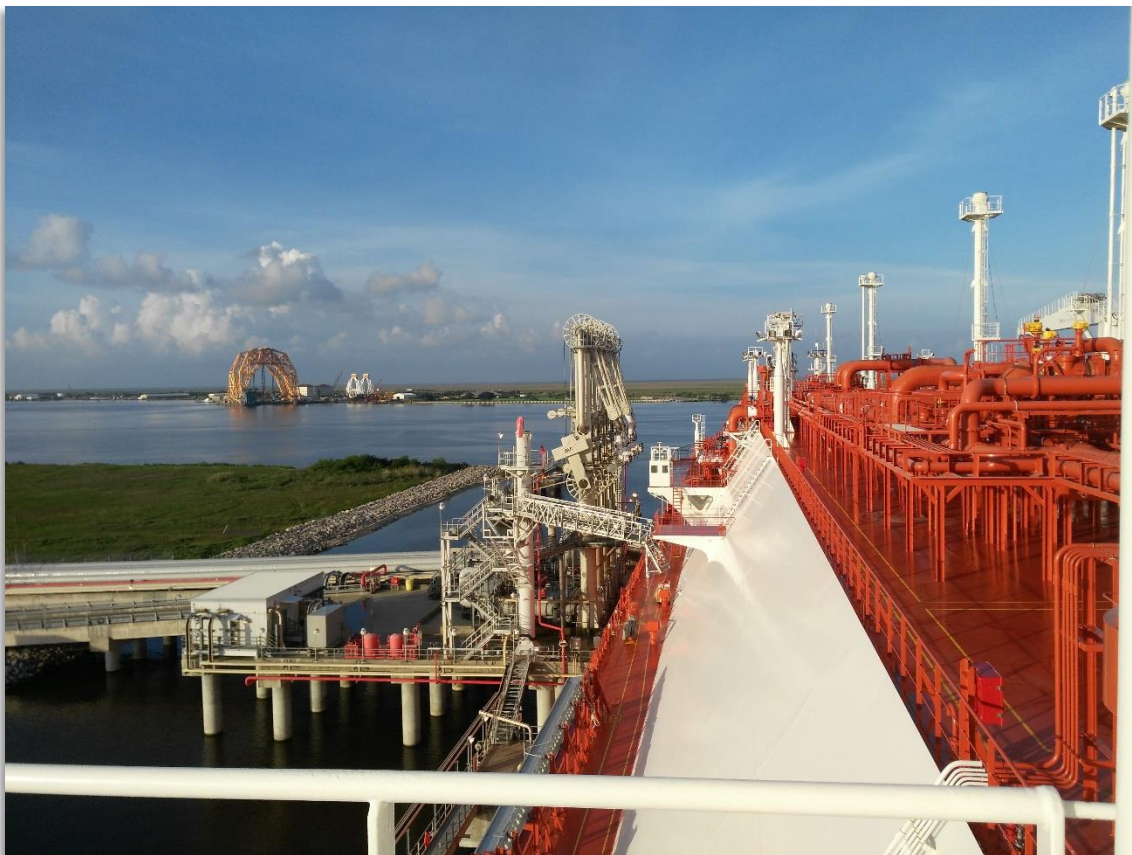
Imagen 28: Vista del manifold de babor del buque LNG/c Rioja Knutsen en Sabine Pass. Fuente: Elaboración propia.
