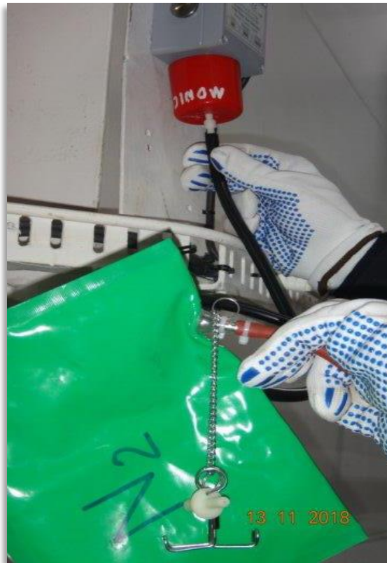
Imagen 33: Prueba de Nitrógeno a un detector de gas. Fuente: Elaboración Propia.
