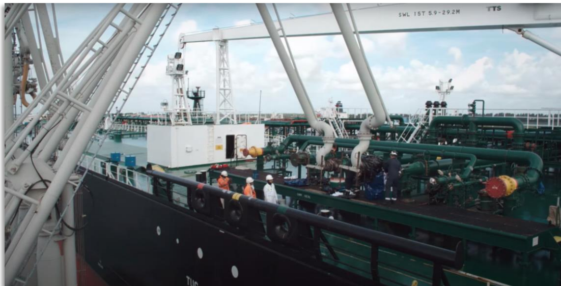
Imagen 35: Conexión de brazos de carga al manifold. Fuente: Kanon Marine Loading Arms
