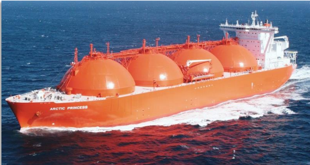
Imagen 20: Buque LNG "Arctic Princess" de tanques esféricos tipo B. Fuente: Global Security (42)
