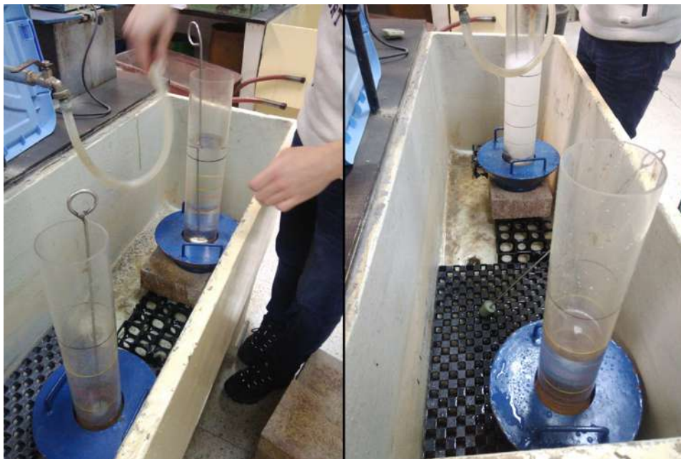
Figura 24. Empleo del permeámetro Laboratorio de Caminos de Santander (LCS) en baldosas de hormigón poroso en laboratorio (Fuente: Elaboración propia).
