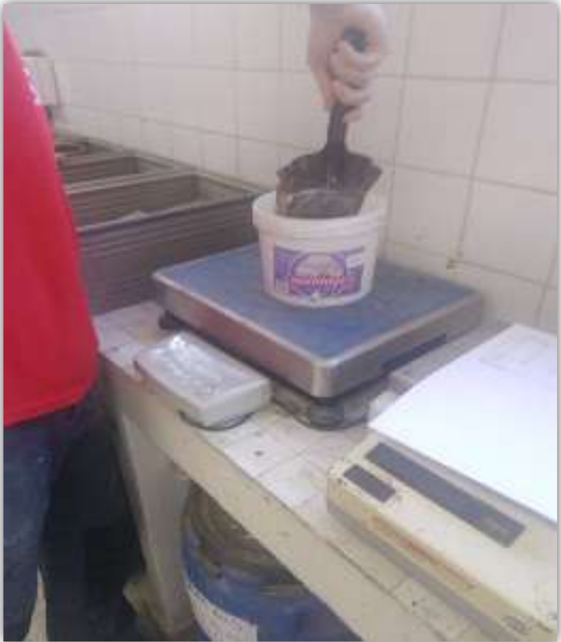
2.- Pesaje de materiales a emplear que componen la mezcla de hormigón poroso.
