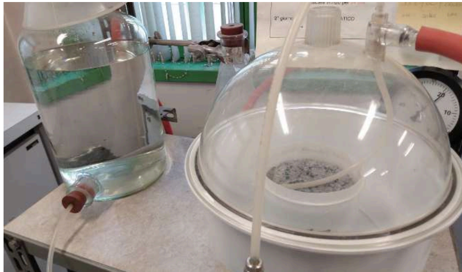
Figura 26. Cámara para remoción del aire, y saturación de las probetas antes de someterlas a resonancia magnética (Fuente: Elaboración propia).
