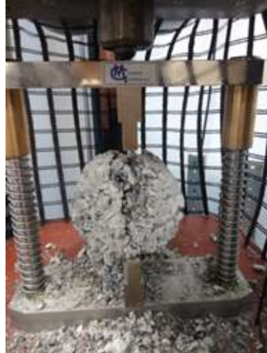
Figura 31. Rotura de una probeta de hormigón poroso mediante el ensayo de Tracción Indirecta (Fuente: Elaboración propia).
