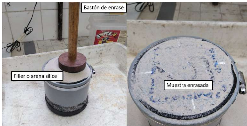
Figura 36. Equipo utilizado en el ensayo del círculo de arena (Fuente: Elaboración propia).
