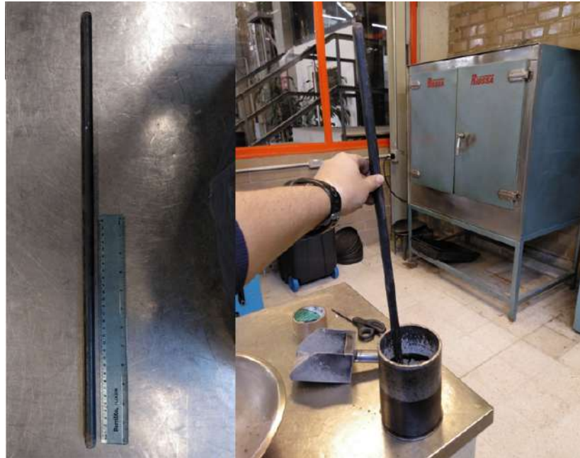
Figura 22. Varilla de apisonamiento para compactación de mezclas de hormigón poroso (Fuente: elaboración propia).
