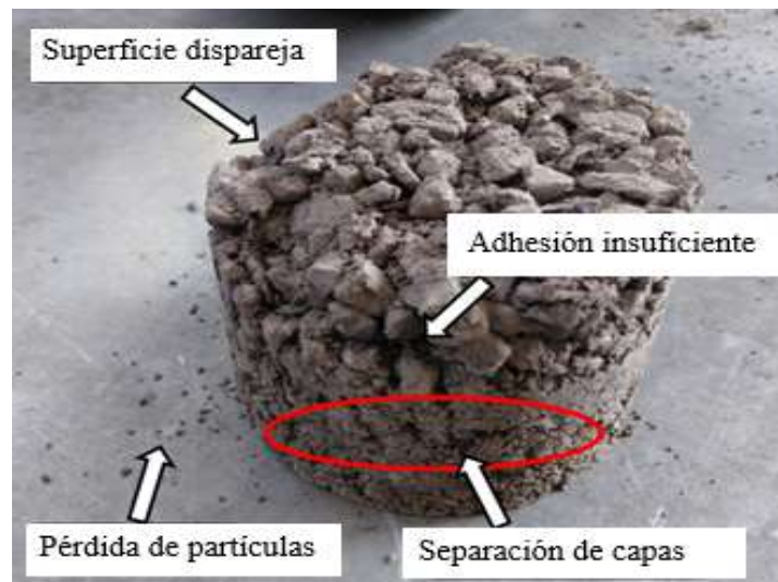
Figura 66. Estudio de métodos de compactación. Ejemplo de una probeta compactada por el método seccionado (Proctor estándar) con la superficie dispareja (Fuente: Elaboración propia).
