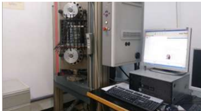
Figura 30. Equipo utilizado para el ensayo a Tracción Indirecta (Fuente: Elaboración propia).
