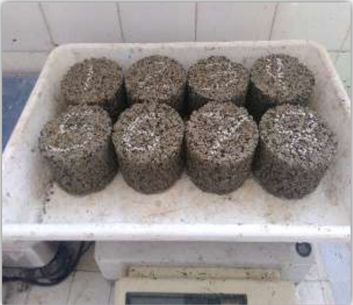
7.- Ejemplo de probetas de hormigón poroso tamaño Marshall ( D=10.2\text{cm} , h=6.5\text{cm} ), listas para ser sometidas a los diferentes ensayos planteados en laboratorio.
