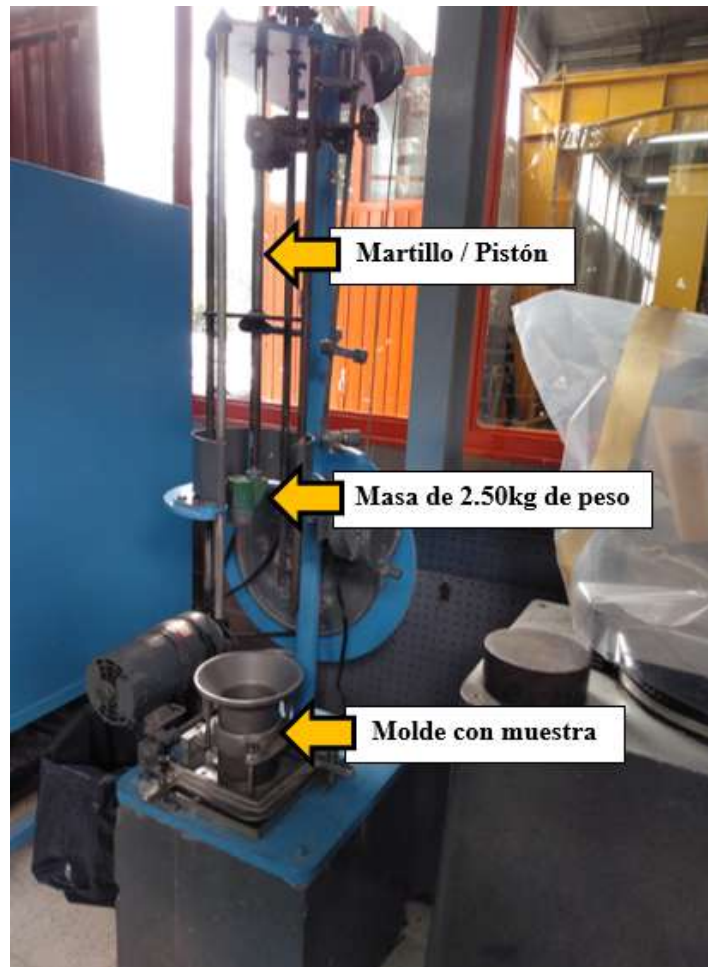
Figura 21. Compactador Proctor para compactación de mezclas de hormigón poroso (Fuente: elaboración propia).
