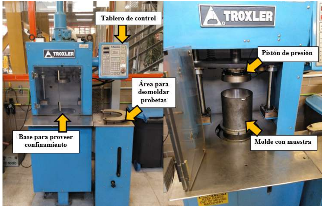
Figura 19. Compactador giratorio para la compactación de mezclas de hormigón poroso (Fuente: elaboración propia).
