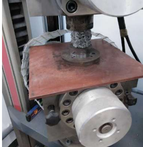
Figura 33. Equipo utilizado para el ensayo a compresión de las probetas cúbicas (Fuente: Elaboración propia).
