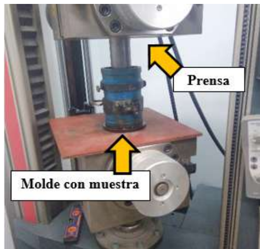
Figura 17. Prensa mecánica utilizada para compactar las mezclas con ofita, por compresión axial (presión) (Fuente: elaboración propia).
