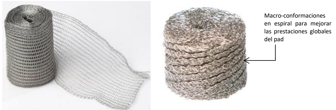
Figura 43. Pad cojín metálico antivibratorio fabricado mediante malla de hilo metálico entretejido, antes del proceso de prensado (izquierda) y posterior al mismo (derecha)
