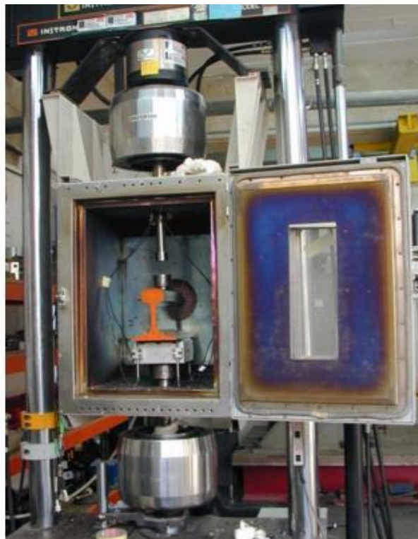
Figura 28. Cámara climática empleada en ensayos sobre sistema de sujeción de carril [70]
