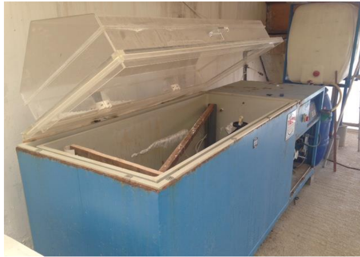
Figura 88. Imagen de la cámara de niebla salina empleada en el ensayo de corrosión acelerada
