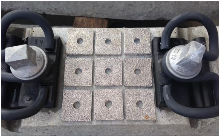
Figura 87. Disposición de las placas metálicas en el ensayo de resistencia eléctrica UNE-EN 13146-5:2003 [6]
