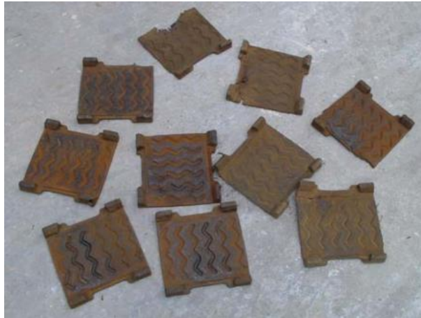
Figura 30. Placas de asiento envejecidas en servicio bajo una sujeción tipo PANDROL [14]
