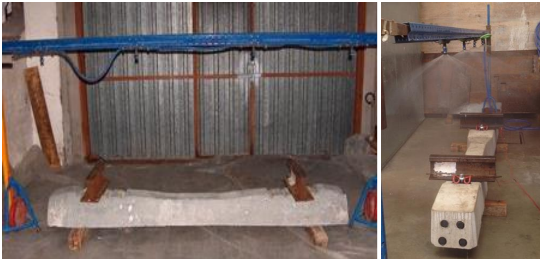
Figura 85. Imagen de la configuración del ensayo para la determinación de resistencia eléctrica
