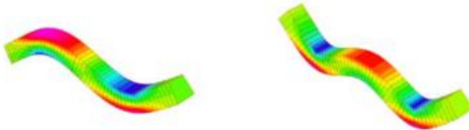
Figura 23. Segundo y tercer modo de vibración en la traviesa debido a la utilización de una placa de asiento muy rígida [13].
