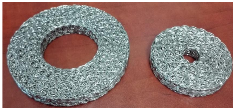
Figura 77. Cojines metálicos axisimétricos empleados en las Fase III de los ensayos
