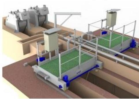
Figura 2: Desarenador y Desengrasador
