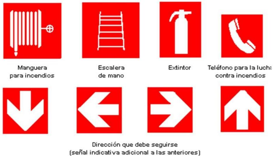
Figura 18: Señalización equipos de emergencia
