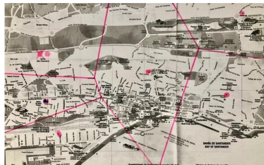
Imagen 17: Diagrama de Voronoi de los seis centros de salud sobre el mapa de Santander.
